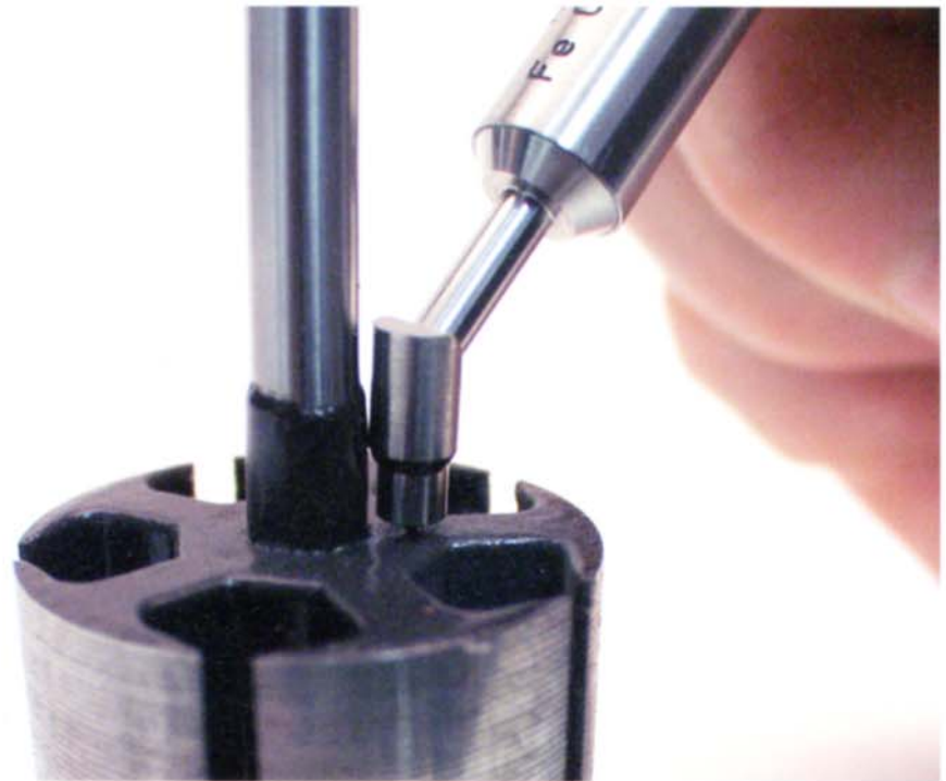
Durch Abschirmung ist das Heranfahren direkt bis an seitliche Bauteilbegrenzungen möglich, hier ein pulverbeschichteter Ankerkörper. Bilder: Karl Deutsch
