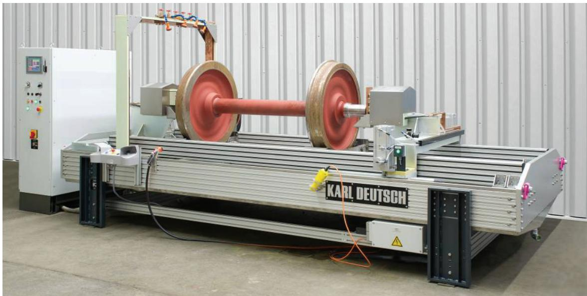
Bild 11. Prüfung von Eisenbahnwellen mit montierten Rädern
