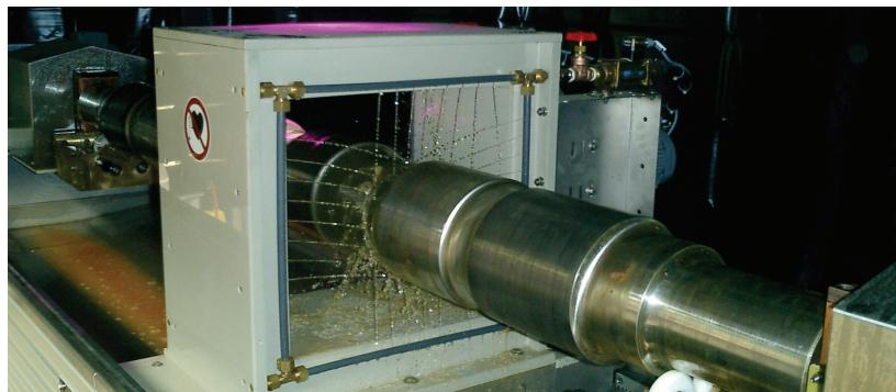
**Bild 4.** Prüfung einer Eisenbahnwelle mit Überlaufspule
