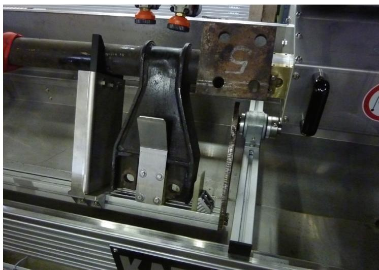
**Bild 14.** Schweißnahtprüfung an den Bauteilenden von Stabilisatoren
