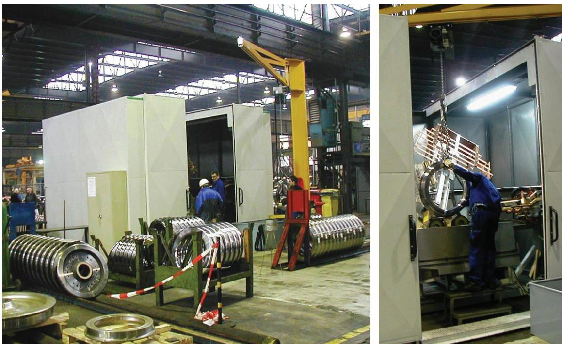
**Bild 15.** Kranbeladung der Prüfmaschine für Räder und Radreifen bei der Bochumer Verein Verkehrstechnik GmbH
