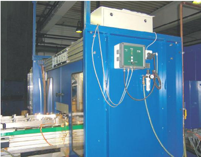
Bild 14: Langzeitversuch von FLUXA-CONTROL in einer bekannten Schmiede. Eine nachträgliche Installation an bereits bestehende Anlagen ist ebenfalls möglich.
