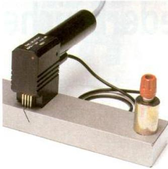
Bild 5. Spezialsonde zur Messung schräger Risse
