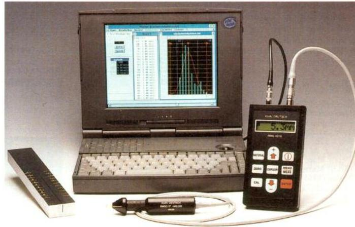
Rißtiefenmeßgerät in Taschenformat mit Sonde, Kalibrierstab und Anschlußmöglichkeit an einen PC
