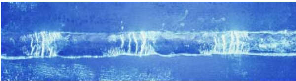
Abb. 10: Rissige Schweißnaht, mit fluoreszierendem Eindringmittel geprüft.
