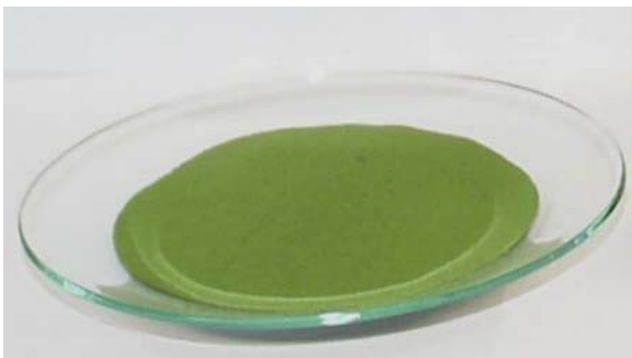
Abb. 4: Trockenprüfmittel, fluoreszierend lackiertes Eisenpulver mit einer mittleren Korngröße von 100 µm.
