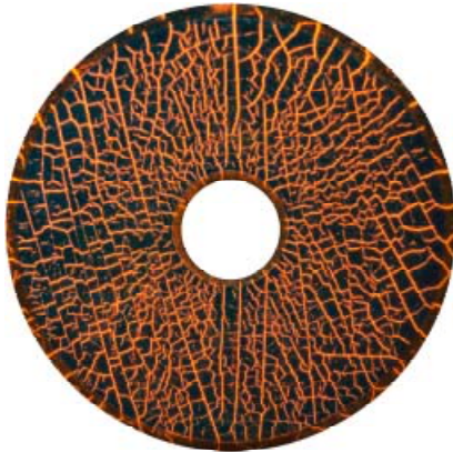
Abb. 3: Rissanzeigebild eines Tageslicht- und UV-fluoreszierenden Magnetpulver-Rissprüfmittels.
