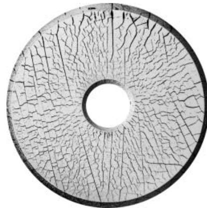
Abb. 2: Rissanzeigebild eines nicht-fluoreszierenden (schwarzen) Magnetpulver-Rissprüfmittels bei gleichzeitiger Verwendung von weißer Untergrundfarbe.
