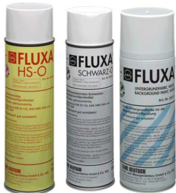
Abb. 8: Gebrauchsfertige Prüfmittelsuspensionen werden bei der mobilen Prüfung und in Form von Aerosolen eingesetzt.
