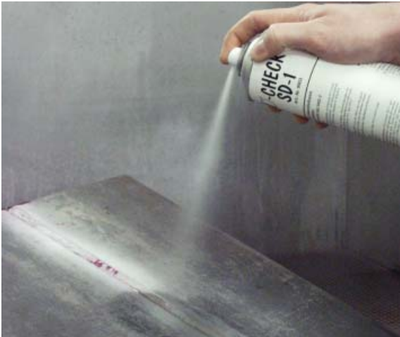
Abb. 12: Der Nassentwickler auf Lösemittelbasis muss gesprüht werden.
