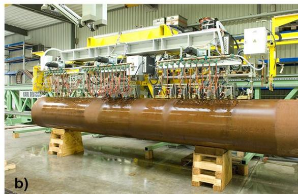
**Bild Inbetriebnahme der beiden Schweißnahtprüfanlagen.** a) links im Bild die Prüfanlage zur Vorprüfung mit zwei Prüfwagen und b) Prüfanlage zur Abschlussprüfung mit drei Prüfwagen und 30 Prüfköpfen.
