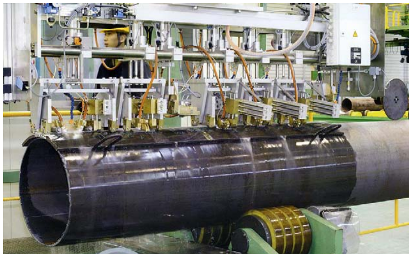
Bild 12: Schweißnahtprüfanlage. Prüfanlage im Werk Erndtebrück-Malaysia mit zehn Prüfköpfen zur Längsfehler-, Querfehler- und Dopplungsprüfung, Empfindlichkeitsjustierung mit einer Blechschale.
