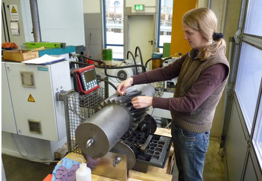
Bild 5: Prüfanordnung. Ultraschall-Prüfung an Verzahnung einer Getriebewelle.
