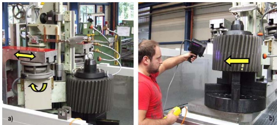
Bild 7: MT-Prüfung an Zahnrad. a) Zustellung und Winkelverstellung der horizontalen Magnetisierjochs, b) die MT-Prüfung erfolgt in einer vollen Umdrehung des Zahnrads (die Drehrichtung ist durch den Pfeil gekennzeichnet), die Auswertung unter UV-Licht erfolgt durch den Prüfer.
