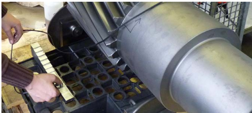
Bild 6: Justierung. Anhand des Testkörpers mit 1 mm KSR in verschiedenen Tiefenlagen wird die DAC-Kurve auf dem Prüfgerät erzeugt bzw. regelmäßig überprüft.
