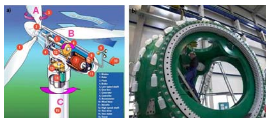
Bild 4: Getriebe in Windkraftanlage. a) Getriebe zur Verstellung der Rotorblätter (A), Getriebe im Antriebsstrang (B) und Getriebe zur Ausrichtung der Gondel entsprechend der Windrichtung (C) [11], b) ein Größenvergleich zeigt die imposanten Ausmaße dieser Komponenten [1].
