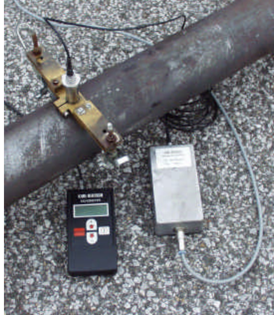
Bild 2. Messstelle mit festinstalliertem Wanddickenprüfkopf, Wanddickenelektronik und Datensichtgerät
