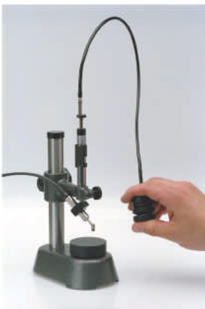
Bild 1. Präzisions-Positioniereinrichtungen ermöglichen genaues und praktisch kraftfreies Aufsetzen auf das zu messende Werkstück
