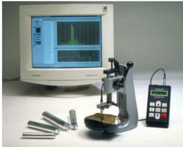
Bild 2. Beim neu entwickelten Tubenmeßplatz wurde eine für das Wirbelstromverfahren ausgelegte und mit der entsprechenden Sonderkennlinie ausgestattete Mikrosonde direkt in einen Druckstempel integriert
