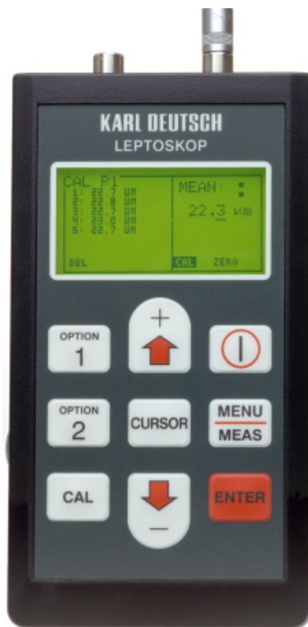
Bild 1: Leptoskop zur Messung der Schichtdicke
