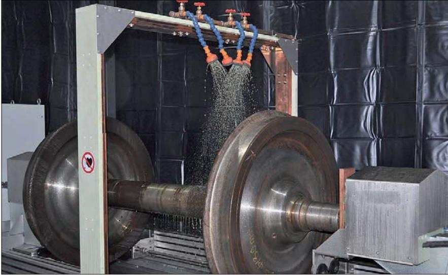
Prüfung einer Welle; die Räder bleiben montiert
