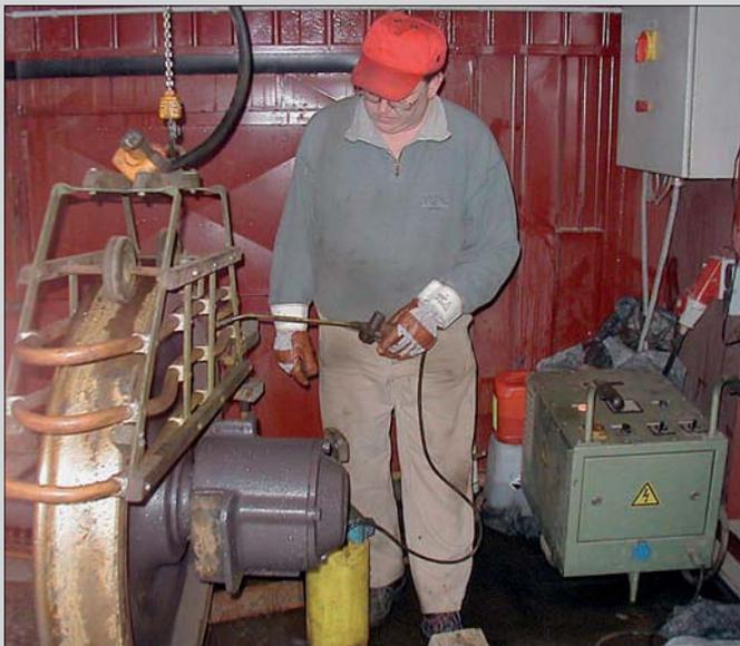
MT-Radprüfung mit Stromerzeuger und spezieller Hochstromspule
