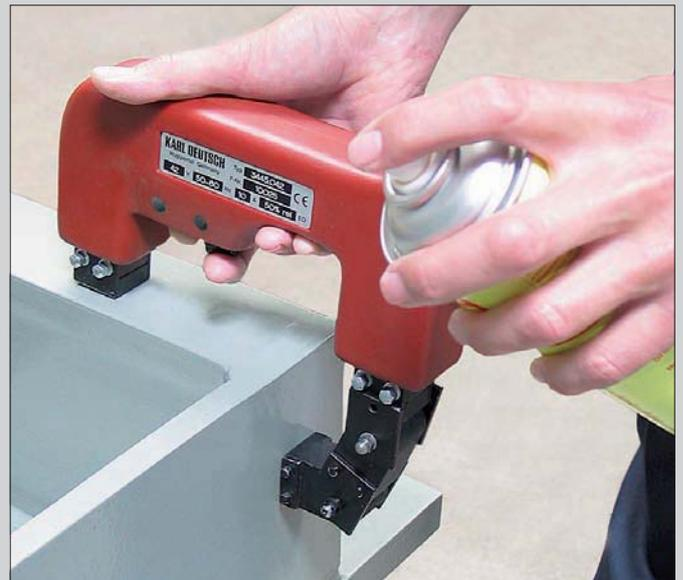
Schweißnahtprüfung mit DEUTROPULS-Handmagnet
