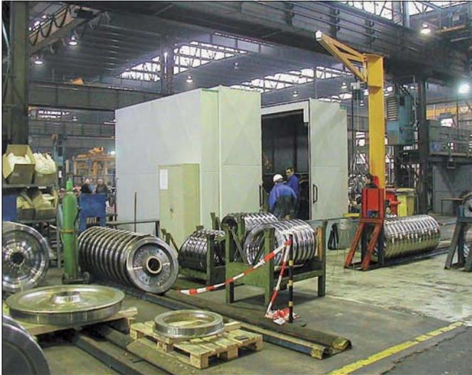
Prüfkabine und Kran zur Beladung der Maschine
