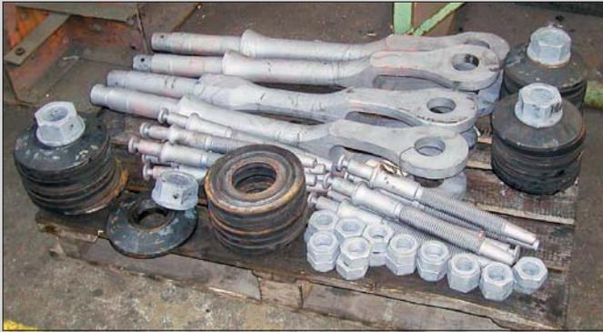
Typische Prüfteile für die Oberflächen-Rissprüfung
