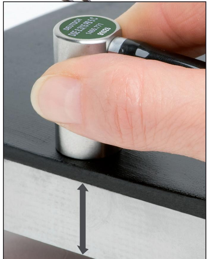
**Wanddicken und Schallgeschwindigkeiten einfach und zuverlässig messen - auch durch Beschichtungen**
