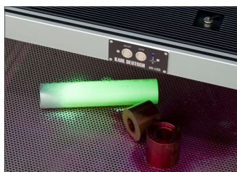
Prüfung mit der Großflächenleuchte unter UV-Licht
