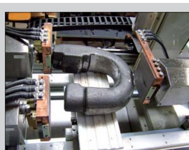
Prüfmaschine mit Überaufspule und drei Kontakten zur Prüfung großer Haken
