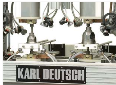
Prüfung von zwei Gehäusen mit zwei vertikalen Magnetisierstationen
