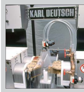
Links: Prüfung von Gabeln mit drei Kontakten; rechts: Auswurf und Prüftisch
