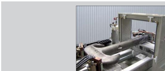
Prüfmaschine mit Überaufspule und drei Kontakten zur Prüfung großer Haken
