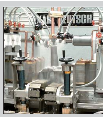
Links: Prüfung von LKW-Achsschenkeln; rechts: Detailansicht, vier Kontakte
