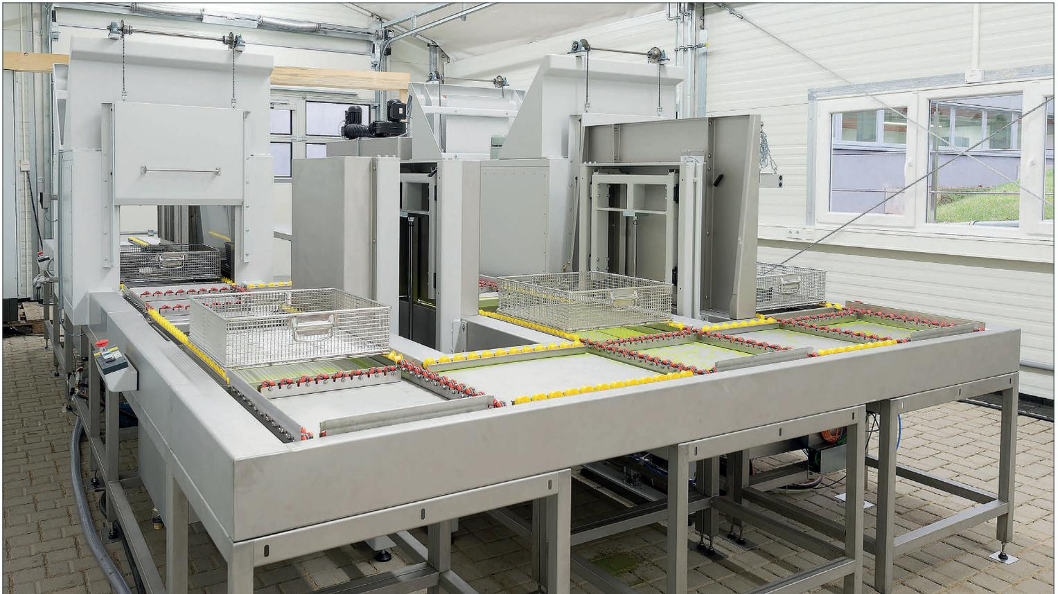
Halbautomatische Prüfanlage mit Vorreinigung und zwei Tauchbecken für Prüfmittel mit unterschiedlicher Empfindlichkeit
