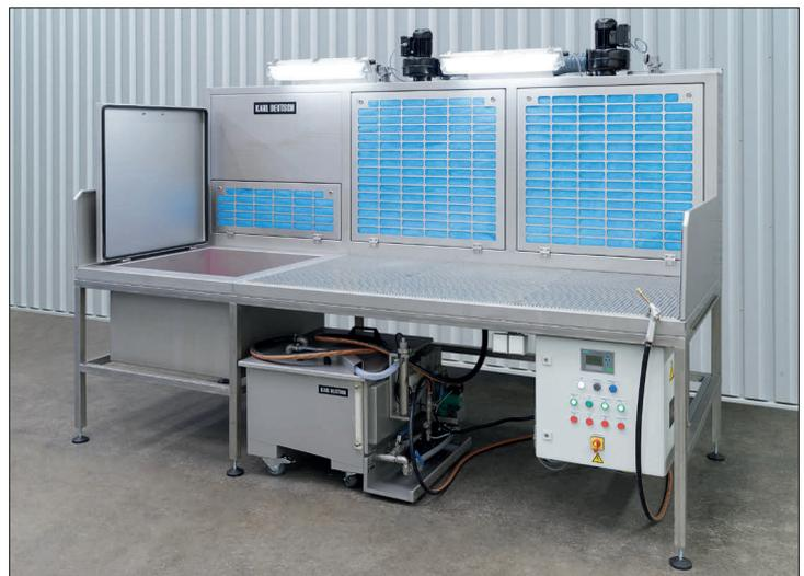
Prüfplatz mit Tauchbecken für die Prüfung mit rotem Farbeindringmittel und die Auswertung unter Tageslicht
