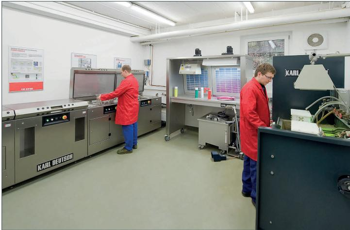
Drei anwendungstechnische Labore stehen in den beiden Werken in Wuppertal für kundenspezifische Versuche zur Verfügung. Die Ausstattung umfasst auch komplette MT- und PT-Prüfanlagen, um Prüftechnik und Rissprüfmittel optimal festzulegen und Versuche an Kundenbauteilen zu ermöglichen.
