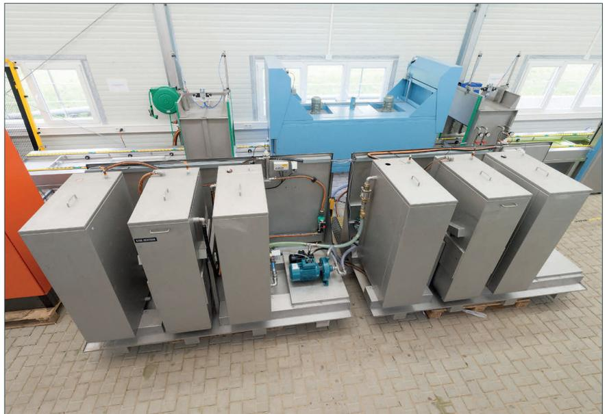
Kreislaufführung des Waschwassers: Regenerierung mit Aktivkohle über doppelte Kolonne
