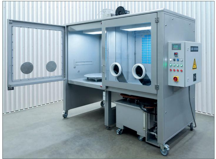
Sonderprüfplatz mit Spritzschutztüren und integrierter Trockenkammer
