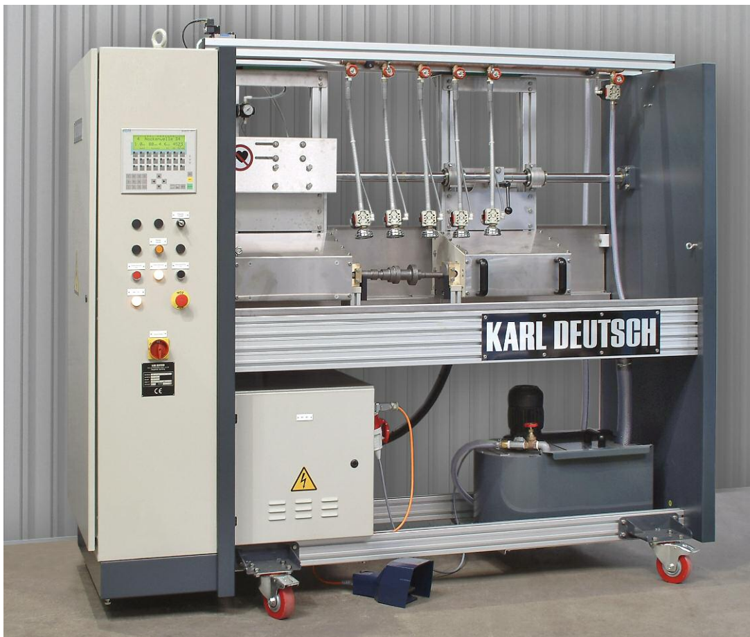
Bild 1: DEUTROFLUX UWE 900 mit Parameterspeicherung und Prüfdokumentation.
