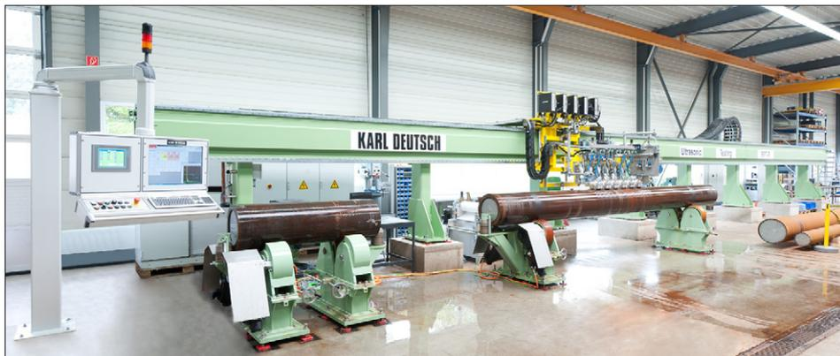
Foto einer ähnlichen ECHOGRAPH-RPTR-Prüfanlage für dickwandige, nahtlose Rohre mit sechs Prüfkopf-Clustern
