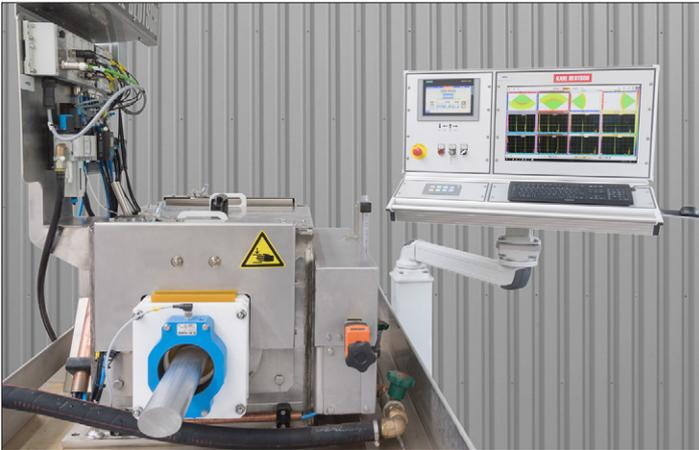
**ECHOGRAPH-HRPS-PAUT Tauchtank-Prüfanlage für ovale Aluminium-Stangen**
