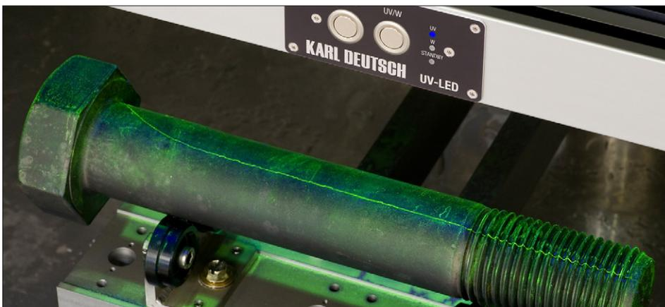
Prüfung mit der LED-Großflächenleuchte unter UV-Licht
