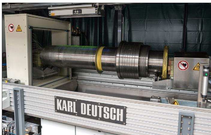
Optimierte Prüfung durch eine individuelle Sektionalregelung für die starken Durchmessersprünge im Verlauf des Prüfteils.
