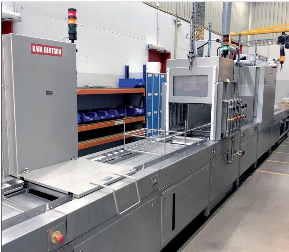
**Für einen namhaften Kunden in Luxemburg wurde diese halbautomatische PT-Anlage für die Prüfung von Ventileilen konzipiert und gebaut.**
