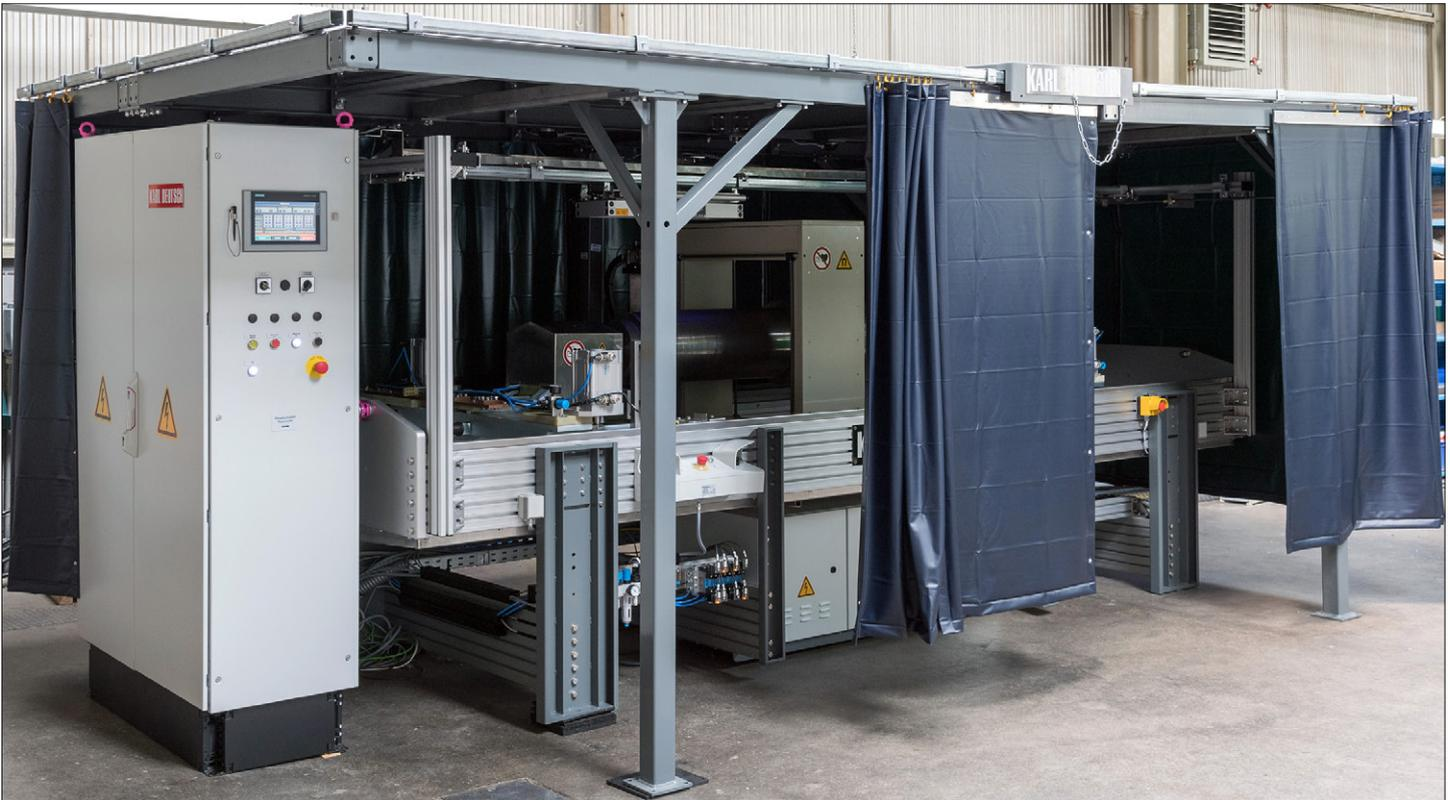
Prüfung einer Turbinenwelle im Zuge der Maschinenabnahme mit unserem Kunden. Hierfür wurde die Anlage mit der Verdunklungskabine in einer der Fertigungshallen von KARL DEUTSCH vollständig aufgebaut und vorgeführt.
