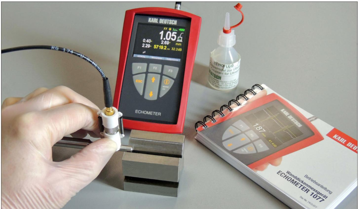
Messung der Wanddicke einer metallischen Schutzhülse an mehreren Umfangspunkten zur Beurteilung der Exzentrizität
