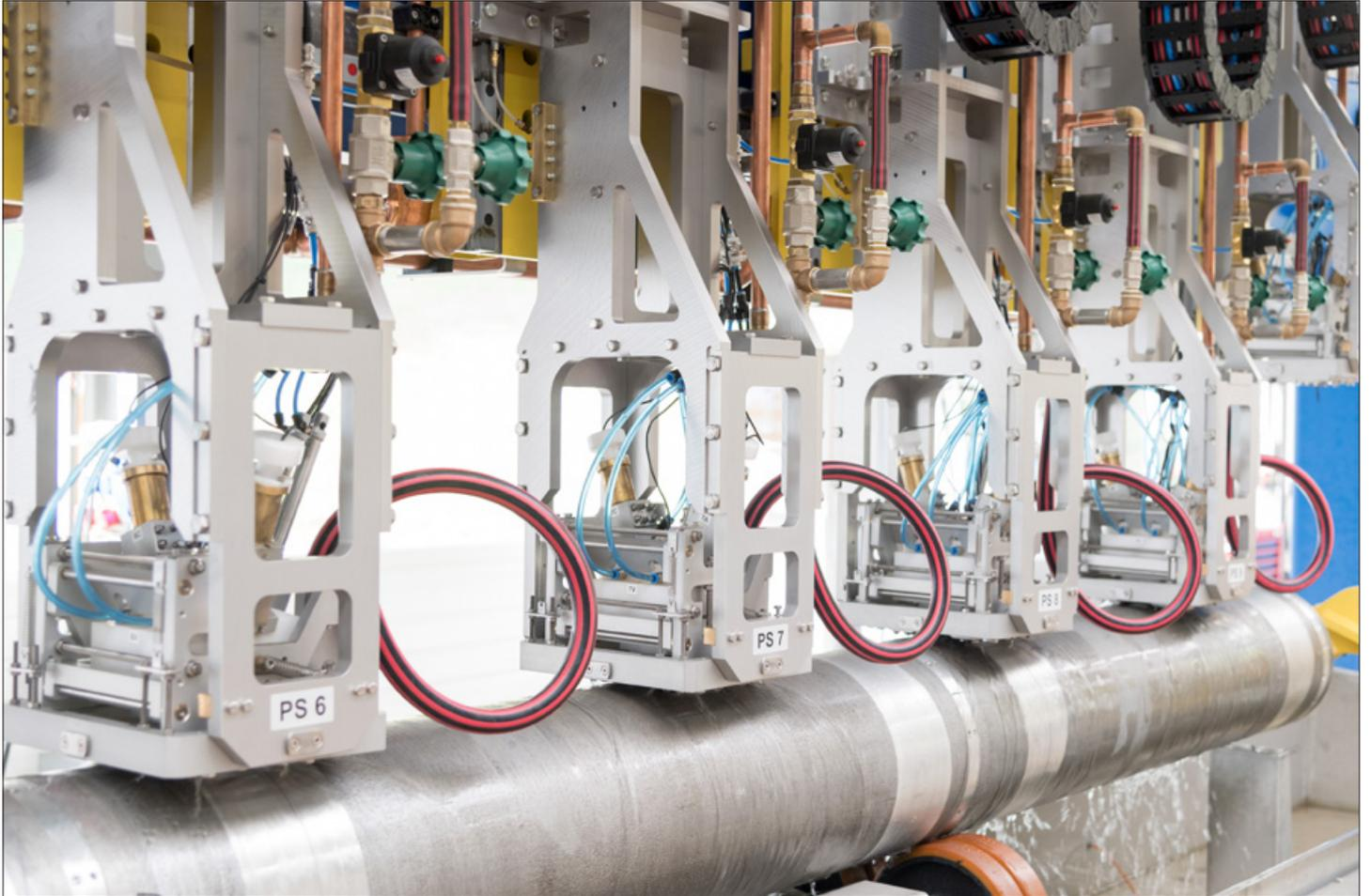
Kardanisch aufgehängte Prüfsysteme mit jeweils einem Senkrechtprüfkopf und zwei Winkelprüfköpfen
