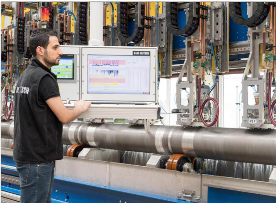
Komfortable Justierung der Prüfanlage durch seitlich verfahrbares Bedienpanel
