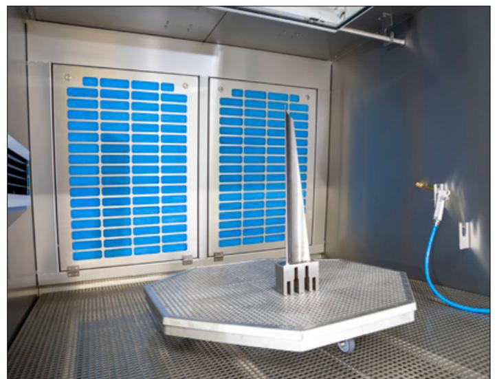
Prüfkammer mit Drehteller und innenliegenden Anschlüssen für Wasser und Druckluft (mit einem Laborprüfteil)
