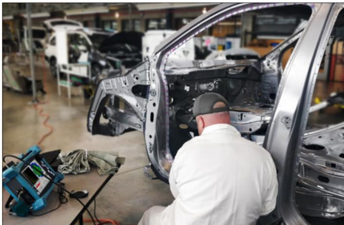
Das Bild wurde während eines Geschwindigkeitstests aufgenommen, der erneut bestätigte, dass das UT/x in der Lage ist, Punktschweiß-Prüfergebnisse im Bruchteil einer Sekunde zu lesen, zu analysieren und zu klassifizieren.
