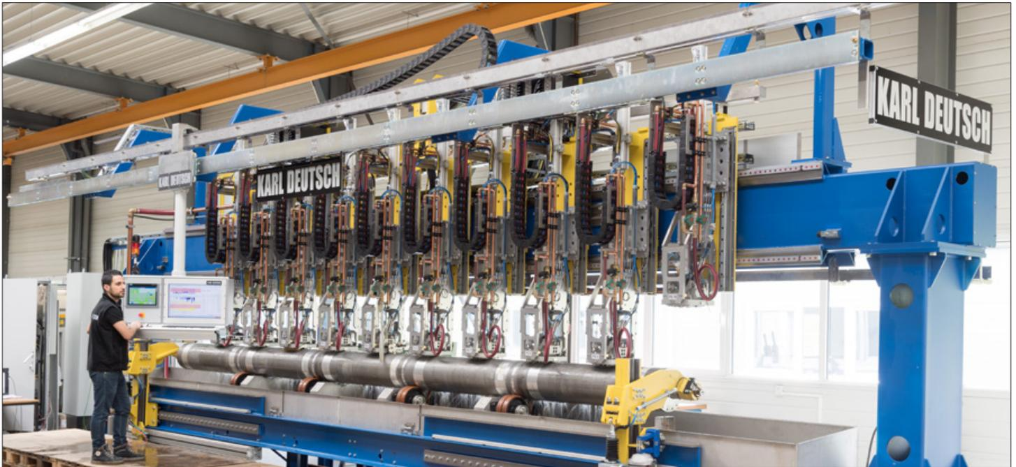
**ECHOGRAPH-ALPT-Prüfbrücke für Aluminium-Rundbarren mit acht Prüfsystemen**
