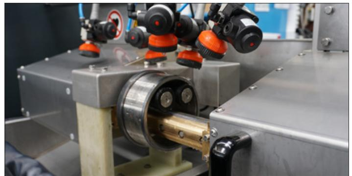
Magnetisier-Einheit für die Ringprüfung mit dezentralem Dorn
