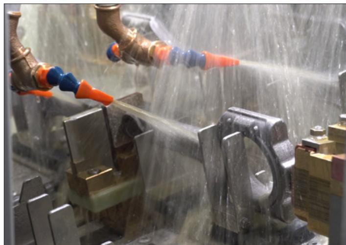
Pleuellagerprüfung in einem DEUTROMAT mit Kettenförderer
