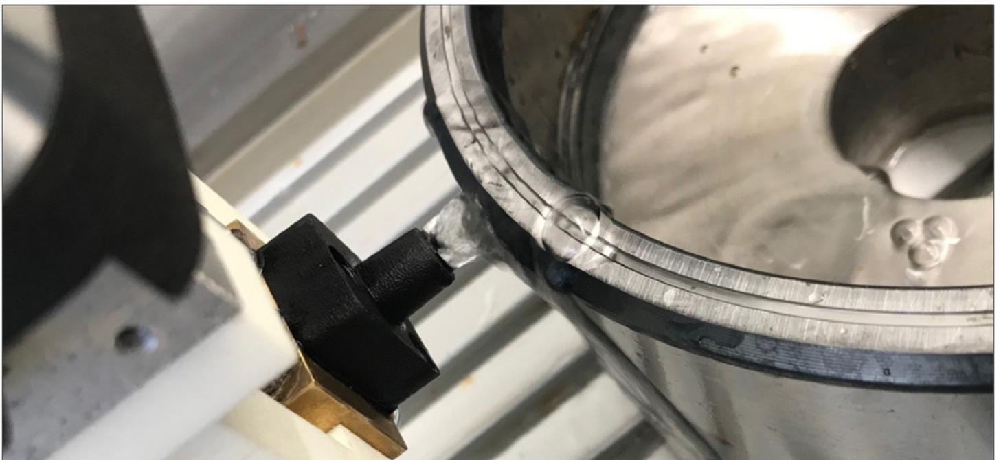
**Wasserdüsen-Ankopplung zur Lagerringprüfung mit Roboter**
