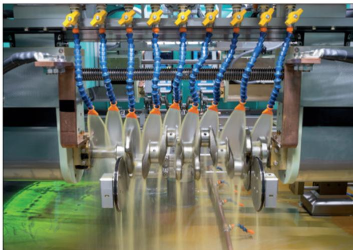
DEUTROMAT Pleuellagerprüfung mit zwei Kontakten
