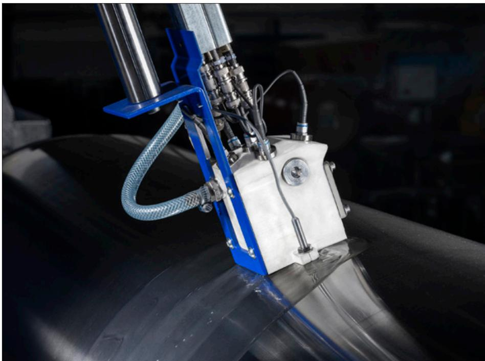
**Prüfkopfhalter mit Fließwasserankopplung, bestückt mit fünf ECHOGRAPH Ultraschallsensoren für die Walzenprüfung**
