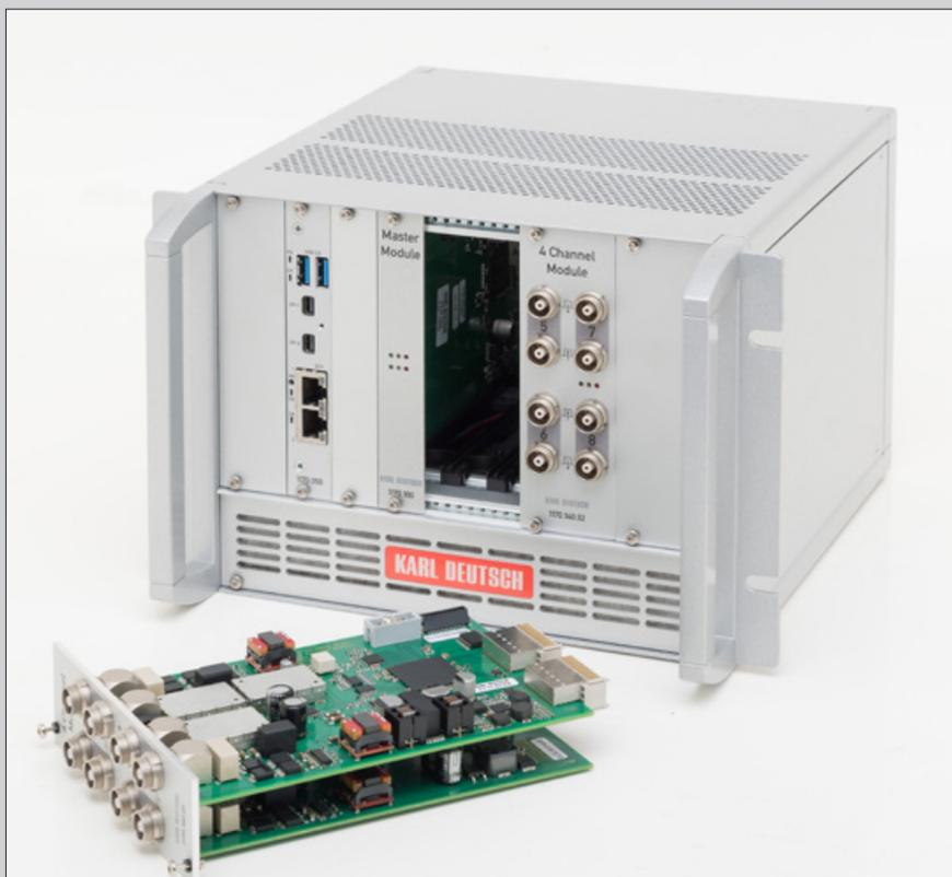
Die ECHOGRAPH 1170-Prüfelektronik basiert auf sehr kompakten, vierkanaligen Modulen, die entsprechend der Kanalzahl zusammengeschaltet werden. Da auch spezielle Durchschallungsverfahren unterstützt werden (z. B. zur Nodularitätsprüfung an Gussteilen), sind acht LEMO-Buchsen zu sehen.
