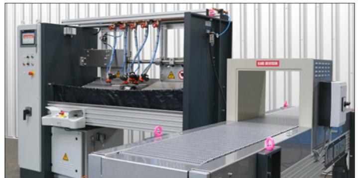
Transportband mit integrierter ESV-Entmagnetisierspule
