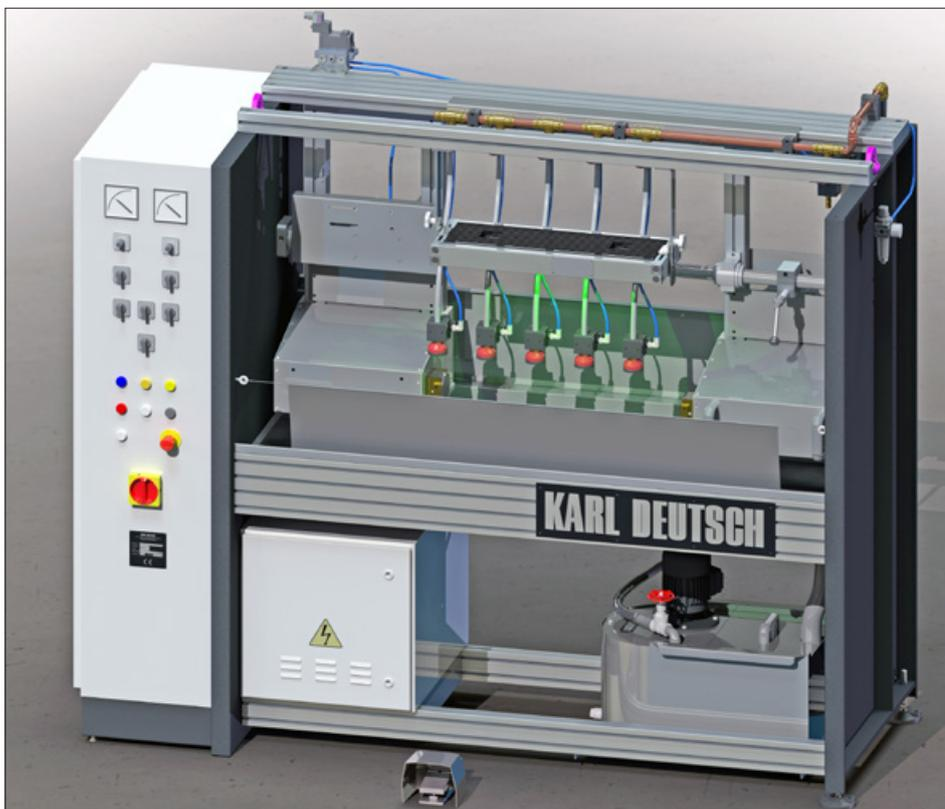
DEUTROFLUX-UWE-Rissprüfanlage mit zwei Kontakten und UV-LED-Grossflächenleuchte
