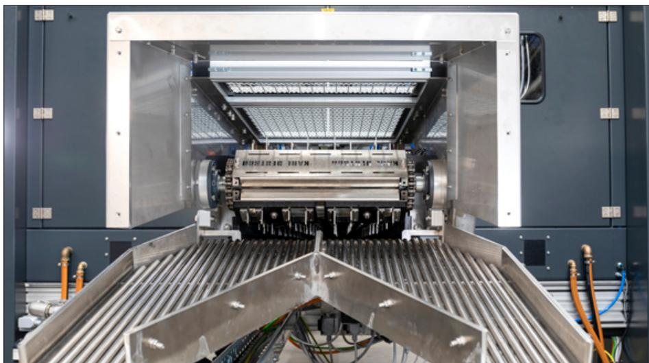
**Auslaufseite der Magnetisierstation mit räumlicher Trennung und Übergabe der aufmagnetisierten und bespülten Teile an die Transportbänder**
