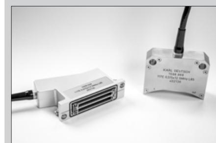
Beispiele für Phased-Array-Prüfköpfe zur Stangenprüfung, die mit bis zu 128 Elementen in diversen Krümmungsradien und Prüffrequenzen gefertigt werden.
