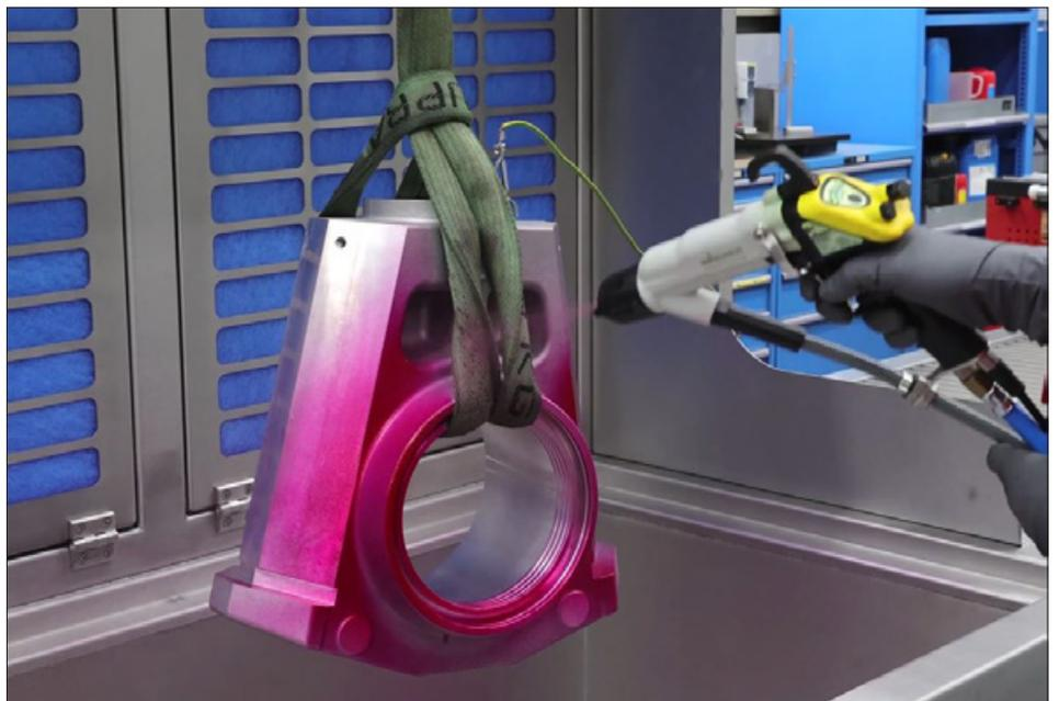
Prüfmittelauftrag an der Eindringmittelstation mit Elektrostatik
