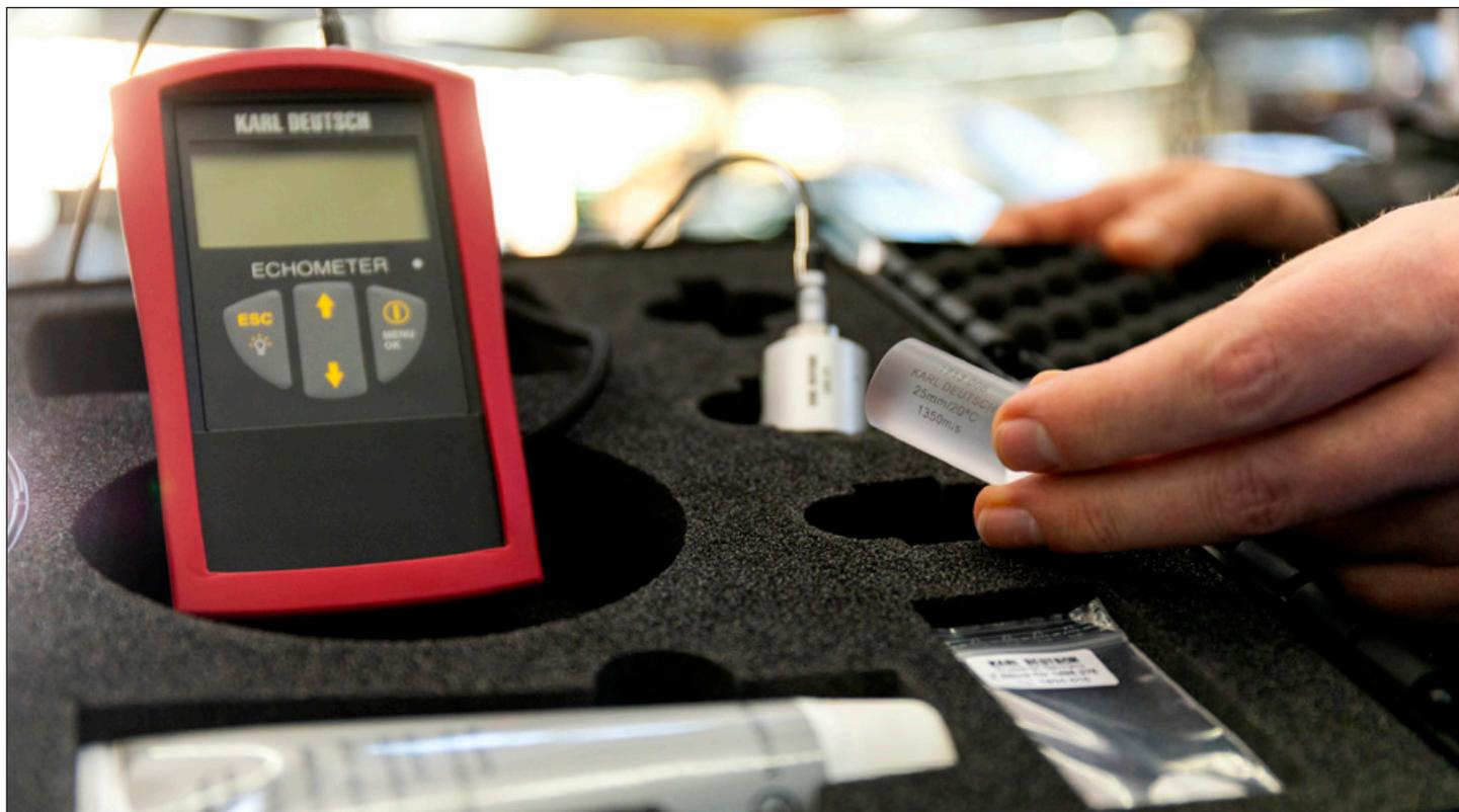
Neu-Entwicklung für Mercedes-Benz: ein innovatives Ultraschallmessgerät für die Messung des Getriebeölstandes
