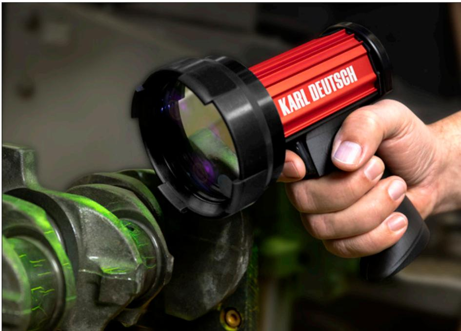
Ein großes Leuchtfeld und der ASTM-Spiegelfilter sorgen für eine optimale Risserkennbarkeit und machen die Leuchte zum idealen Werkzeug für den MT-/PT-Prüfer.
