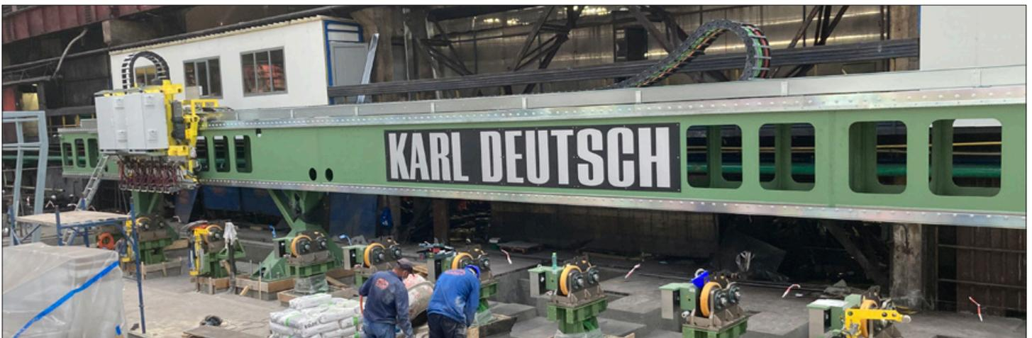
Vorbereitung von Vergusstätigkeiten für die ausgerichteten Drehrollenstationen zusammen mit den Rohrstoppern und der Prüfbrücke
