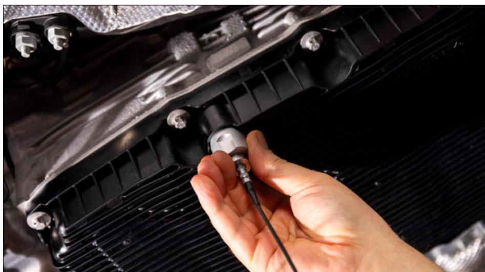
Der Ultraschallsensor wird über einem Bajonettanschluss mit der Getriebe-Ölwanne verbunden.
