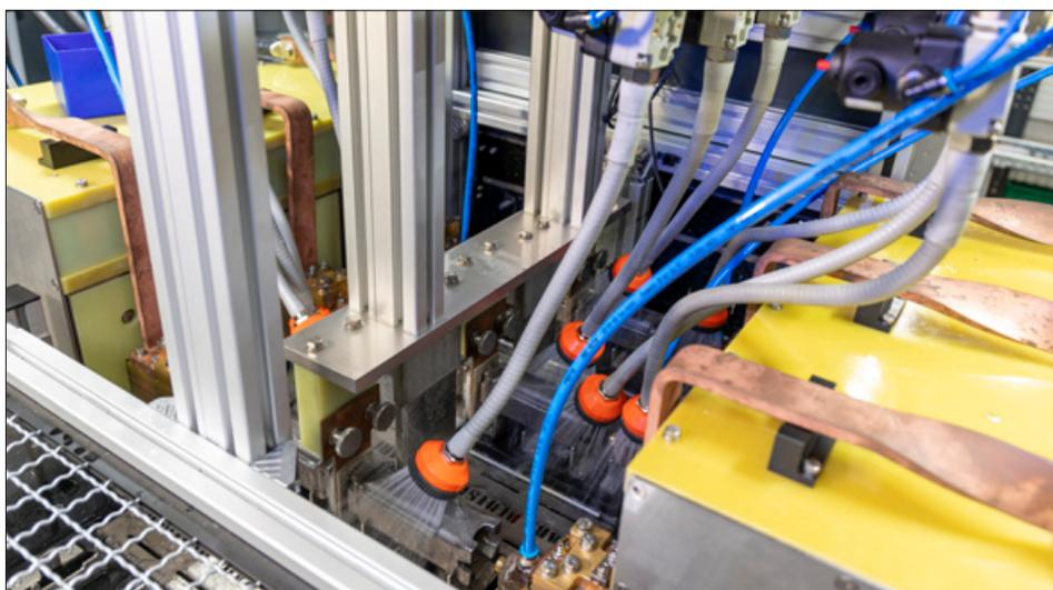
**Magnetisierstation für simultane Prüfung von 6 Bauteilen**
