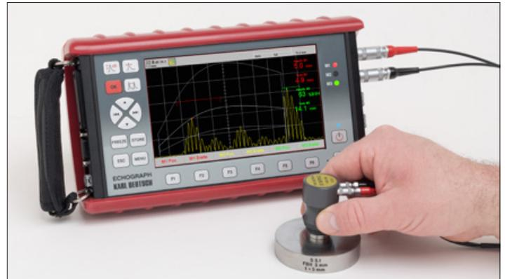
AVG-Prüfung mit SE-Prüfkopf bei aktivierter Rückwandabsenkung
