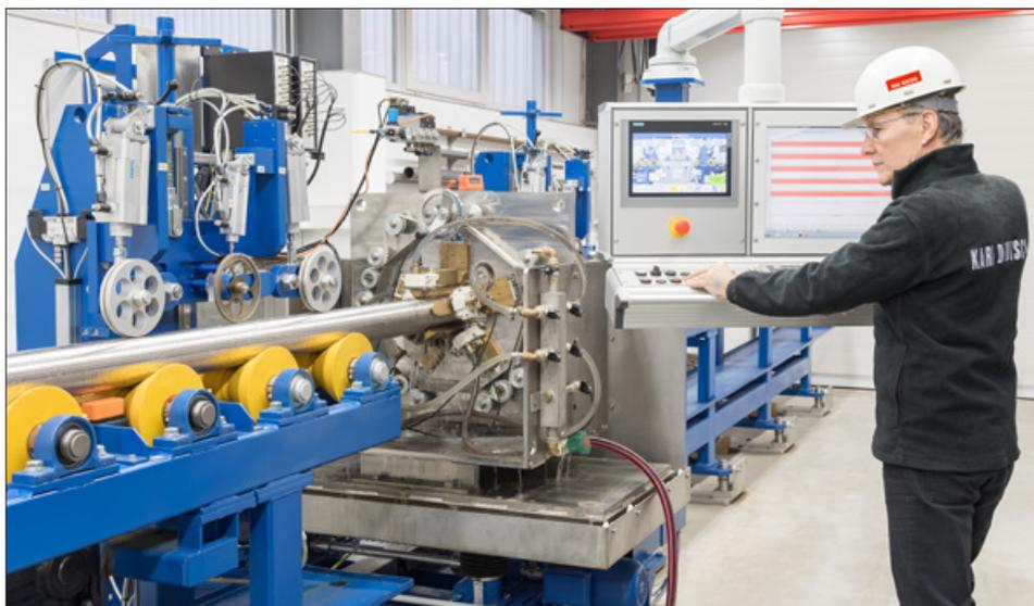
Das KARL DEUTSCH-Labor für Ultraschallprüfanlagen verfügt über einen Rollengang und ermöglicht Versuche im dynamischen Betrieb mit realistischen Prüfgeschwindigkeiten, auch zu kundenspezifischem Material. Mehrere Referenzstäbe mit unterschiedlichen Durchmessern stehen zur Verfügung. Sie enthalten künstliche Fehler, die von der BAM Anstalt für Materialforschung und -prüfung in Berlin hergestellt und zertifiziert wurden.
