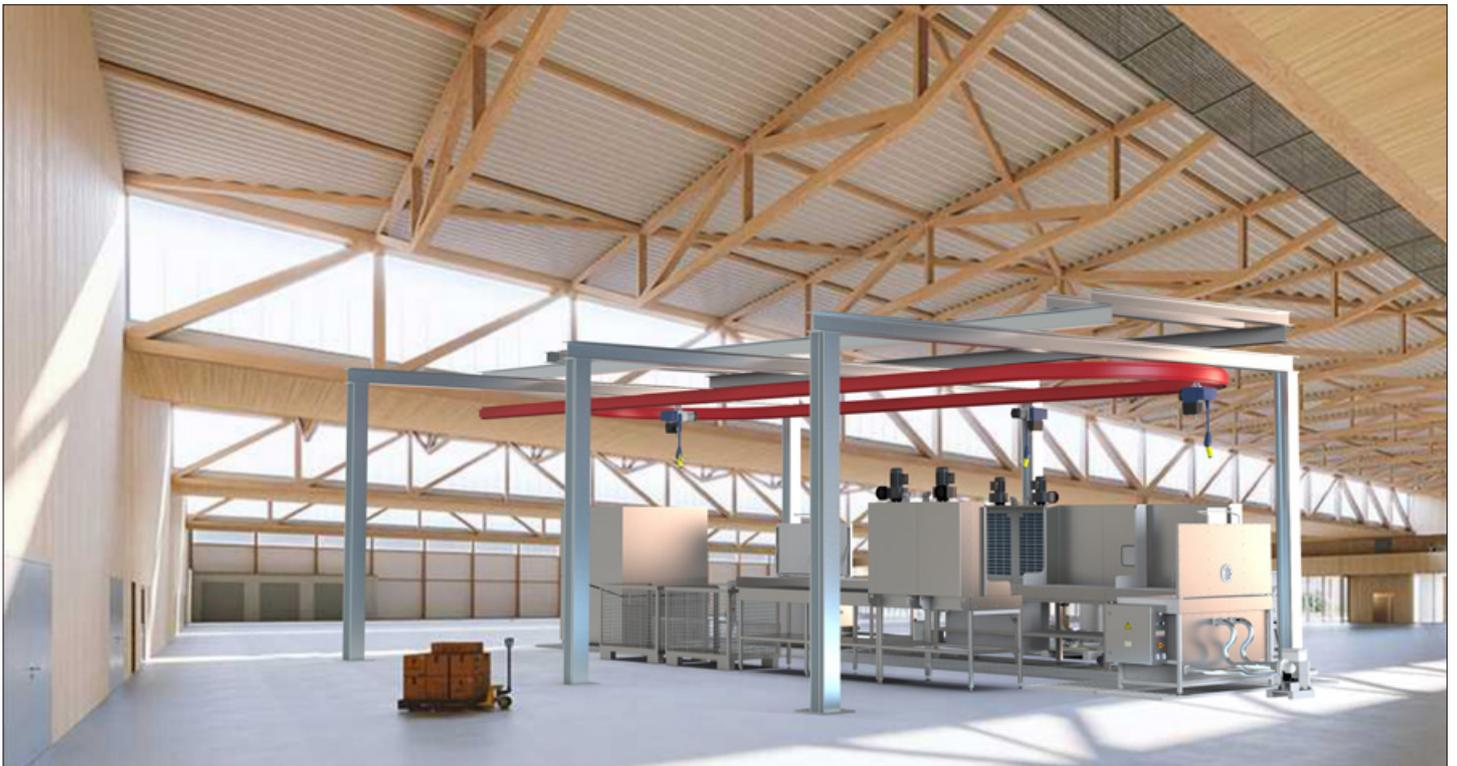
Layout der manuellen Farbeindringprüfanlage mit Kranbahn
