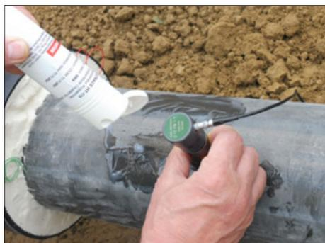
Prüfung mit ECHOTRACE HT-170
