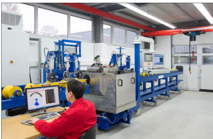
ECHOGRAPH HRPS PAUT-Stangenprüfanlage im Prüflabor von KARL DEUTSCH – jederzeit einsatzbereit für kundenspezifische Versuche!
