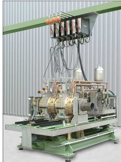
Ansicht des Prüftisches mit Verschiebbarkeit und mit zwei Eintauchprüfkammern. Das gezeigte System ist für Rohrdurchmesser bis zu 170 mm ausgelegt. Es werden Längsfehler erkannt und die Wanddicke gemessen. Es werden 40 Ultraschallkanäle verwendet.
