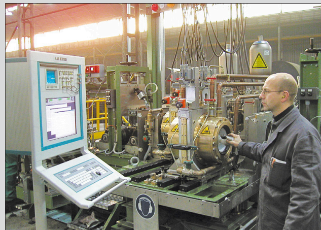
Schnelle Anlagenkalibrierung durch automatische Empfindlichkeitseinstellung, d.h. jeder Prüfkopf wird auf die gleiche Empfindlichkeit eingestellt.
