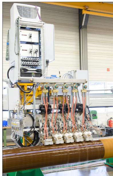
Prüfkopfhalterungen für die Erkennung von Längsfehlern, Querfehlern und Dopplungen. Auch die Wanddicke wird gemessen. In diesem Fall wird die Phased-Array-Technik eingesetzt.
