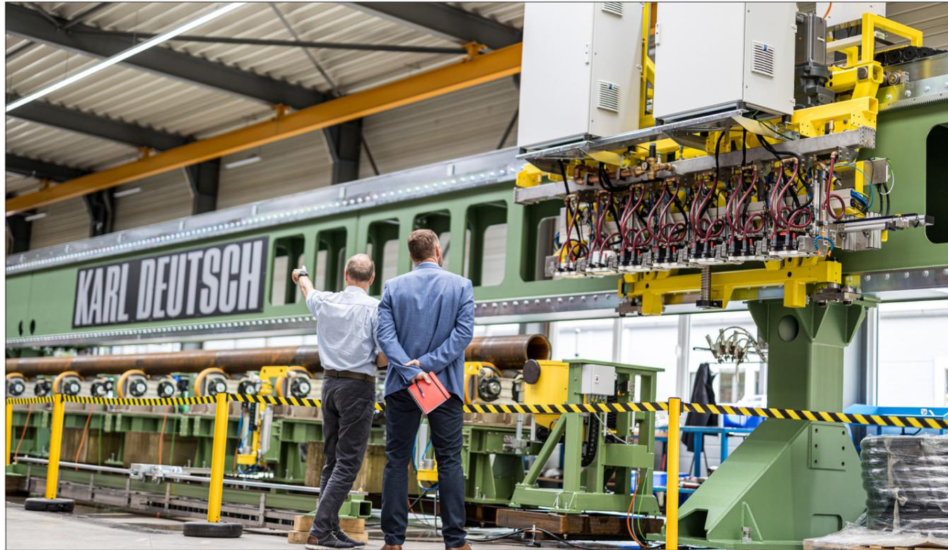
ECHOGRAPH RPTR PAUT-Rohrprüfbrücke bei der Montage im KARL DEUTSCH-Anlagenbau: Dieses System wurde für eine maximale Rohrlänge von 14 m ausgelegt. Eine moderne Phased-Array-Prüfelektronik mit 960 parallelen elektronischen Kanälen wurde zur Detektion von Längs-, Quer- und Schrägfehlern (bis 75°) sowie Dopplung und zur Messung der Wanddicke eingesetzt.
