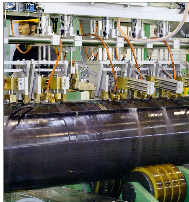
Prüfkopfhalter des Schweißprüfsystems auf einem Rohrsegment zur Kalibrierung des Systems (Bild mit freundlicher Genehmigung von EEW-Korea).
