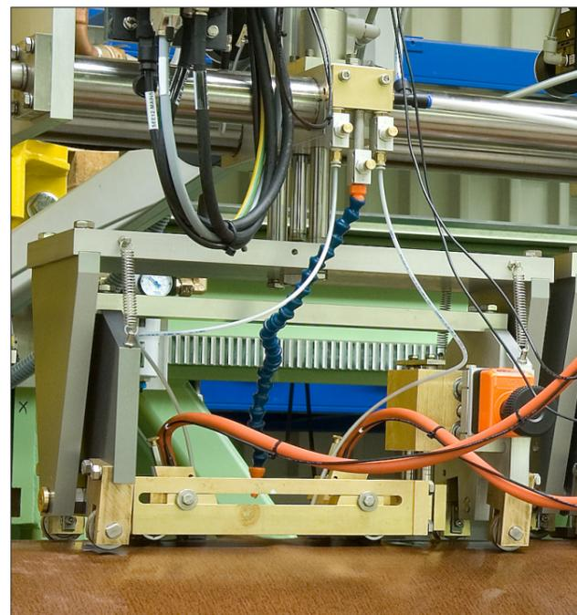
Prüfköpfe für die Querfehler-Erkennung auf der Raupe: Die Wasserstrahlkopplung ermöglicht die Positionierung der Prüfköpfe direkt über der Schweißraupe.
