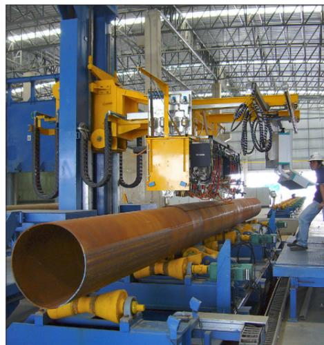
Die Prüfmechanik mit den Prüfkopfhaltern ist auf einem stabilen Maschinenstander montiert. Die Prüfköpfe werden in der Nähe der Schweißnaht in der 12-Uhr-Position und symmetrisch zur Schweißnaht positioniert. Die Höhe des horizontalen Auslegers (in gelb) und die Prüfköpfe werden entsprechend dem Rohrdurchmesser vorpositioniert.
