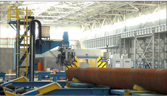
Das Rohr wird mit Hilfe eines Rohrwagens transportiert. Der lineare und der rotierende Vorschub müssen perfekt synchronisiert sein (Bild mit freundlicher Genehmigung von Borusan Mannesmann Türkei).
