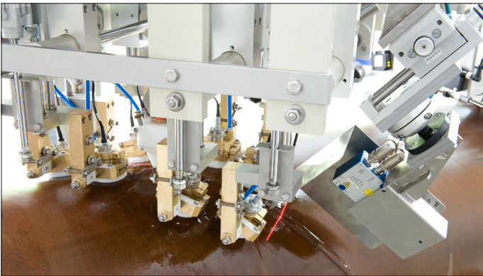
Die Schweißkrone wird kontinuierlich von einem laseroptischen Verfolgungssystem überwacht.
