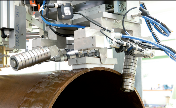
Finale Ultraschallprüfung mit 11 Prüfköpfen: Zwei Prüfköpfe für äußere Längsfehler, zwei Prüfköpfe für innere Längsfehler und zwei Querfehler-Prüfköpfe auf der Naht, vier Prüfköpfe für Dopplungen (WEZ) und ein Prüfkopf für das Rohrende.
