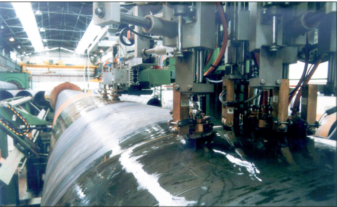
Aufgrund der kompakten Bauweise der Prüfkopfhalterungen konnten alle benötigten Prüfköpfe in einem Prüfraumen montiert werden (rechts im Bild). Der separate Prüfkopfhalter für das Rohrende ist links zu sehen.
