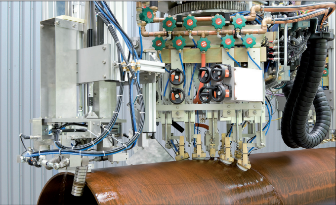
Aufgrund der kompakten Bauweise der Prüfkopfhalterungen konnten alle benötigten Prüfköpfe in einem Prüfraumen montiert werden (rechts im Bild). Der separate Prüfkopfhalter für das Rohrende ist links zu sehen.
