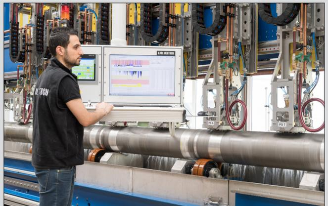
**ECHOGRAPH TTPS:** Die höchste Prüfempfindlichkeit kann aufgrund der bestmöglichen Kopplungsbedingungen mit einem Tauchtank-Prüfsystem
