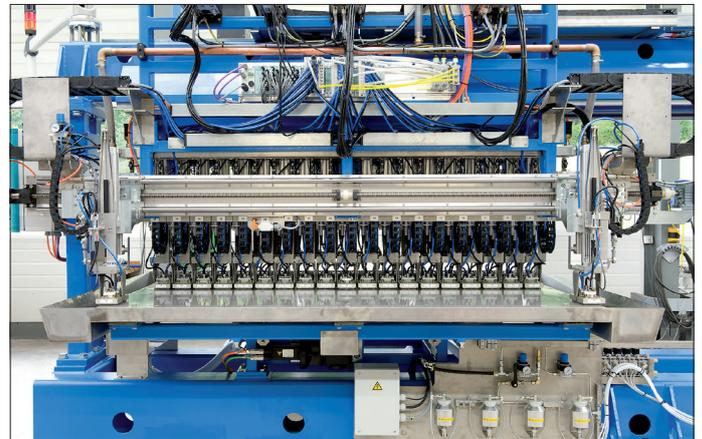
**ECHOGRAPH SNHFS:** Unmittelbar nach dem Schweißen wird eine erste Ultraschallprüfung der Schweißnaht mit einem Online-Schweißnahtprüfsystem durchgeführt. Längsfehler werden mit 4 Prüfköpfen (2 für Außenfehler und 2 für Innenfehler) erkannt. Optionale Prüfköpfe für Dopplungen prüfen die Wärmeeinflusszone. Eine Schabekontrolle mit einem oszillierenden Senkrechtprüfkopf wird manchmal hinzugefügt,
