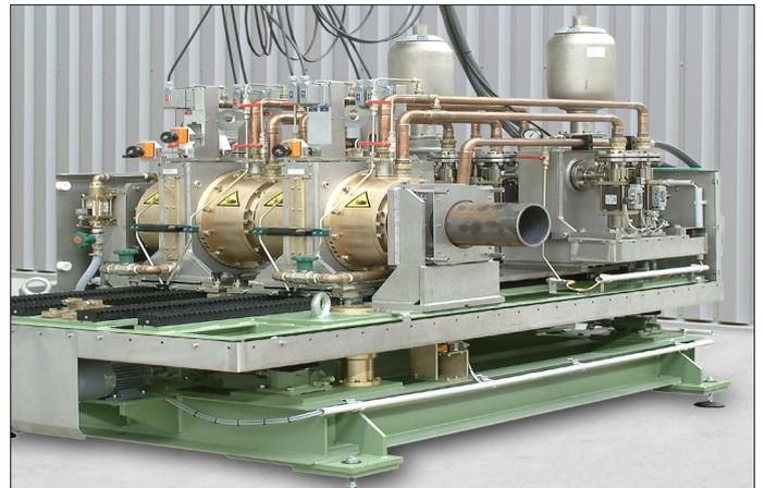
**ECHOGRAPH RPSR:** Rohre mit größeren Durchmessern (z. B. bis zu 610 mm) können mit partieller Tauchttechnik geprüft werden. Die Prüfköpfe werden unterhalb des Rohres in wassergefüllten Kammern positioniert und verbleiben in ihrer Position, während das Rohr schraubenförmig über die Prüfkammern bewegt wird.
