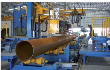
Höhere Durchsätze und bessere Prüfergebnisse lassen sich durch ein Prüfportal mit ruhendem Rohr und linear bewegten Prüfköpfen erzielen (großes Bild).
