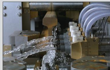
einen guten Zugang zum komplexen und stark gekrümmten Schienenprofil. Die Prüfkopfhalter können von Hand oder vollautomatisch verstellt werden. Die Prüfungsgeschwindigkeit beträgt typischerweise 1 m/s und die Prüfeempfindlichkeit liegt bei 1,4 mm KSR.
