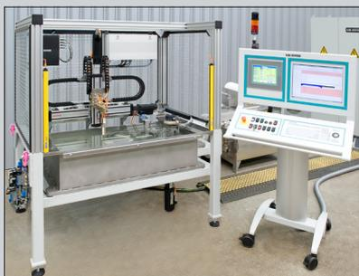
Einschallung des Ultraschallstrahls entweder durch direkte Fehlerechoauswertung oder durch Beobachtung der Rückwandechoabschwächung erfasst werden. Zur Erhöhung des Durchsatzes können mehrere Senkrechtprüfköpfe verwendet werden. Der Ring wird unter Rotation mit schraubenförmigen Prüfspuren geprüft.
