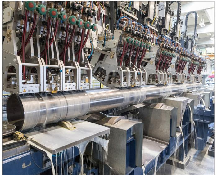
**ECHOGRAPH ALPT:** Bei Knüppel aus Aluminiumguss mit rauen Oberflächen werden die Prüfköpfe in mehrere Prüfkopfhaltungen
