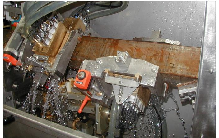
**ECHOGRAPH STPS:** In einem weiteren Prozessschritt werden die Knüppel zu Stangen gewalzt, die noch schwarze Oberflächen haben können. Die Geradheitstoleranzen in dieser Stufe erfordern eine Führung der Prüfköpfe auf der Oberfläche im Bereich von einigen Millimetern. Das Ankoppeln erfolgt mit Wasserstrahlen (Squirtern). Die typischen Durchmesser für diese Prüfaufgabe sind 10 bis 130 mm. Je höher
