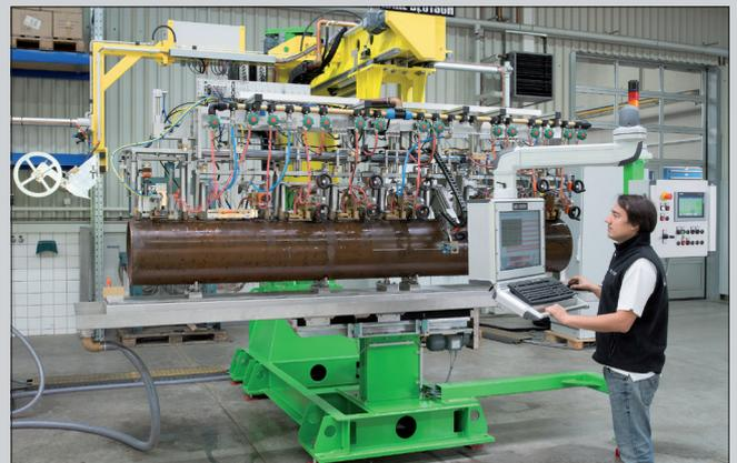
**ECHOGRAPH SNHFT/SNHFB:** Nach dem Schneiden der Rohre und der hydrostatischen Prüfung kann die abschließende Schweißnahtprüfung mit einem Portal oder einer Prüfbrücke durchgeführt werden, bei dem die Schweißnaht in die 12-Uhr-Position gedreht wird. Diese
