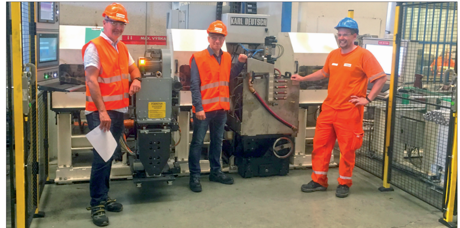
Typischer Aufbau einer ECHOGRAPH STPS PAUT-Prüfanlage mit Rollgang, Wirbelstromprüfanlage und Prüftisch
