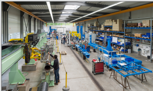
Blick in eine Halle des Anlagenbaus, in der gerade große Rohrprüfanlagen montiert werden. Die hauseigene Teilefertigung liefert die Schlüsselkomponenten.
