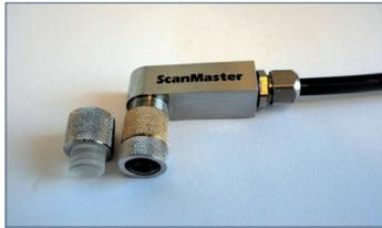
Standardprüfkopf für Schweißlinsen bis 9 mm Durchmesser mit harter Vorlaufstrecke bzw. Wassersäule und flexibler Membran
