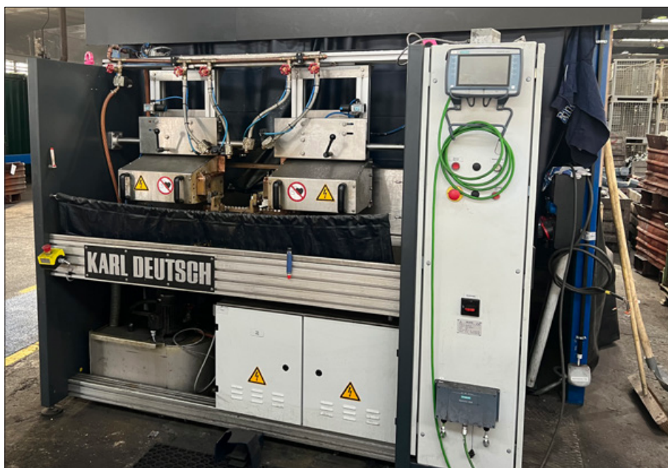
DEUTROFLUX UWE 600 mit Auswerfer und mobilem Bedienpanel
