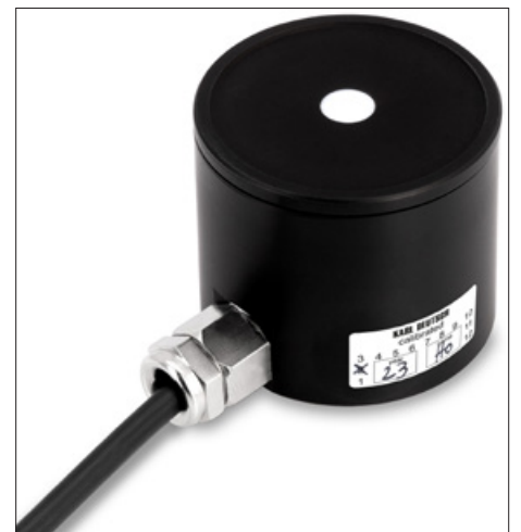
UV- und Weißlichtsonde mit lichtdurchlässigem Diffusor, durch den das Licht zur Messeinheit in der Sonde gelangt
