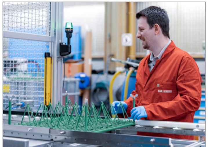
Ausgabestation mit Lichtschranke und Rollwagen
