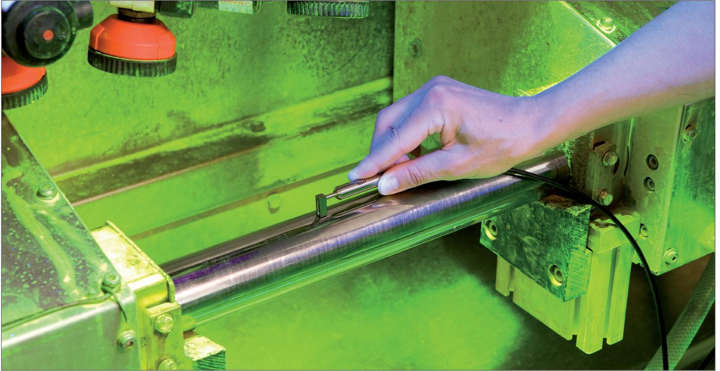
Anwendungsbeispiel: Tangentialfeldmessung mit der 90°-Sonde bei Felddurchflutung
