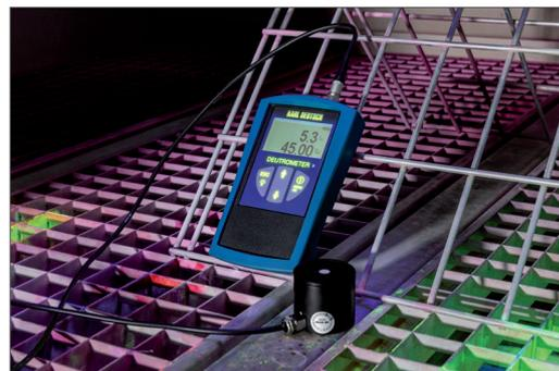
Auch für die Kontrolle der Lichtverhältnisse bei der PT-Prüfung ist das DEUTROMETER das richtige Werkzeug
