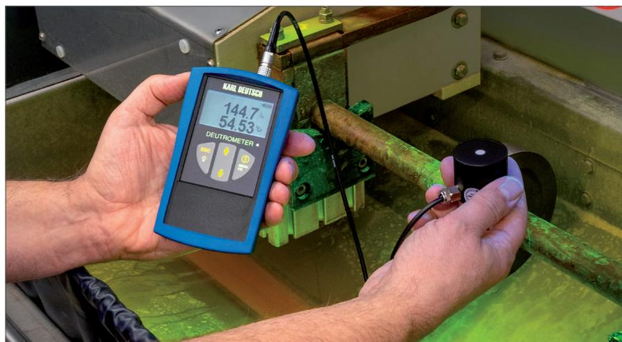
Zur Kontrolle der Betrachtungsbedingungen liefert das DEUTROMETER zusammen mit der DEUTROLIGHT-Sonde gleichzeitig die Messwerte für das Rest-Tageslicht und die UV-Intensität
