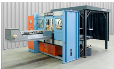
Beispiel für eine konventionelle DEUTROMAT-Magnetpulverprüfanlage mit Betrachtungskabine
