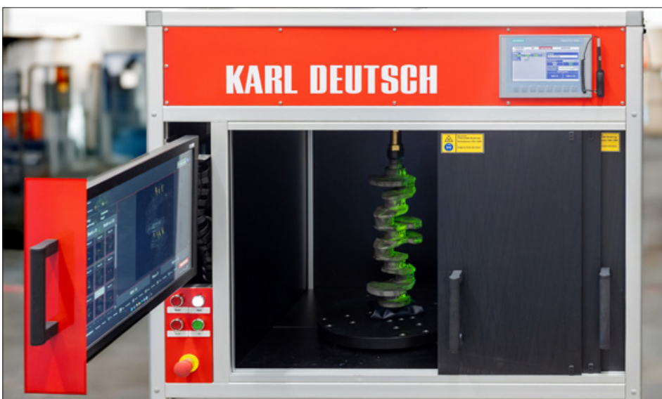
CRACKVIEW AI-Prüfplatz mit Prüfteil auf einem Drehteller
