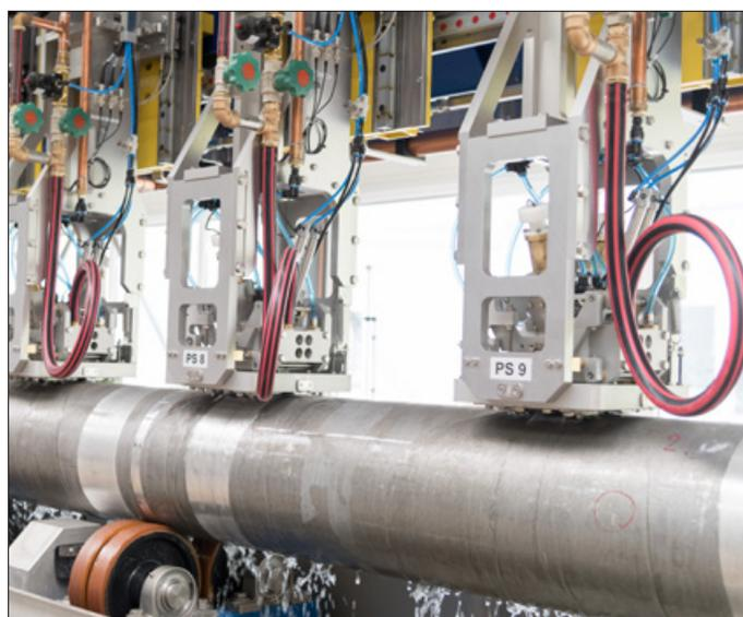
Hier enthält jeder Prüfkopfhalter einen Senkrechtprüfkopf und zwei Winkelprüfköpfe. Die gegossene Oberfläche dieses Barrens aus Aluminium ist relativ rau. Eine große Metallkufe schützt den Prüfkopf und die Wasserdüse vor Beschädigungen.
