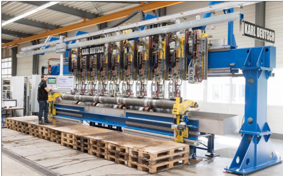
Prüfportal für runde Aluminiumgussbarren mit zehn Senkrecht-Prüfköpfen zur Erkennung von Kernfehlern gemäß ASTM B 594-90. Zusätzlich prüfen Winkelprüfköpfe die Barren auf Oberflächenfehler.
