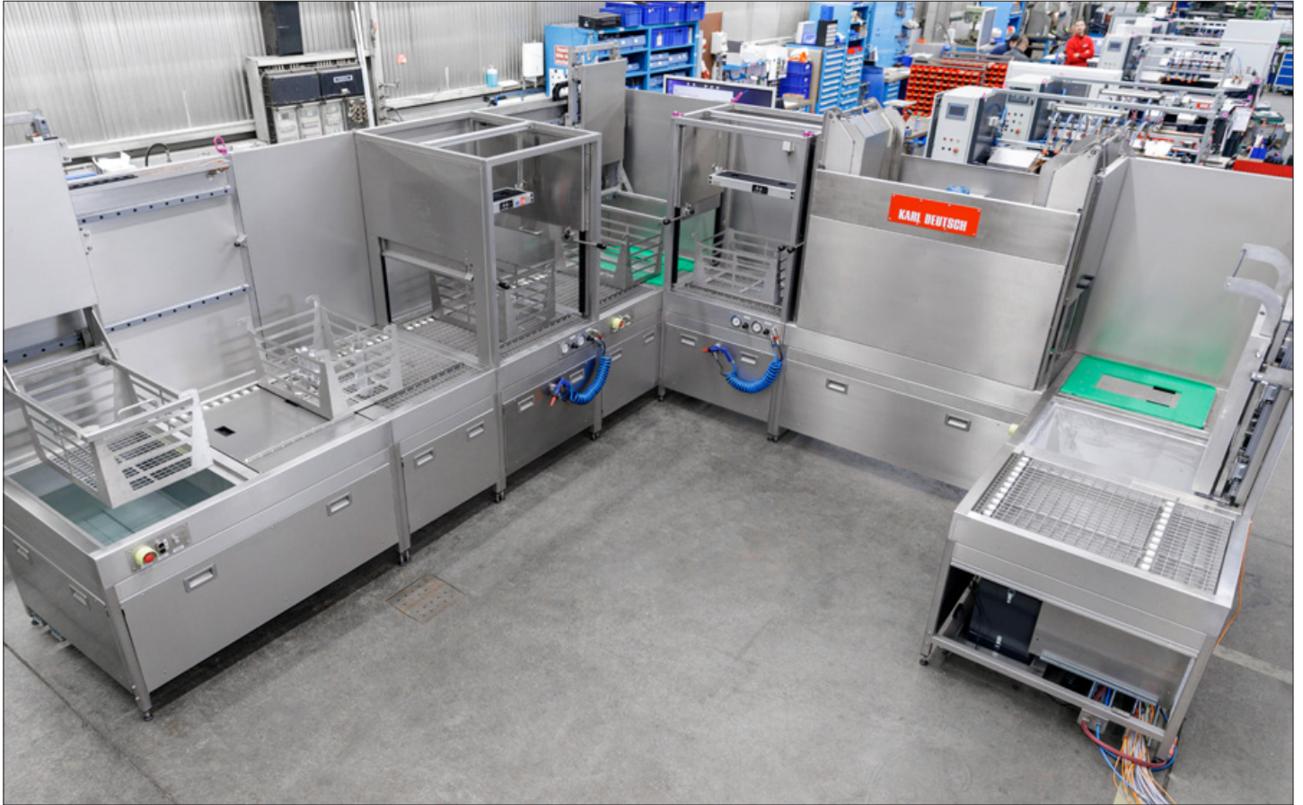
Halbautomatische PT-Anlage für die Verfahren „direkt wasserabwaschbar“ und „nachemulgierbar“
