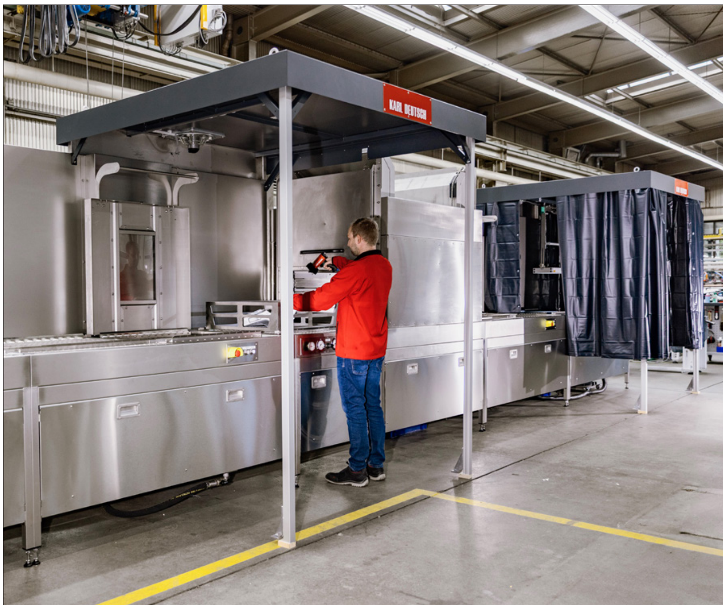
Große halbautomatische PT-Anlage für variables Teilespektrum und hohe Stückzahlen
