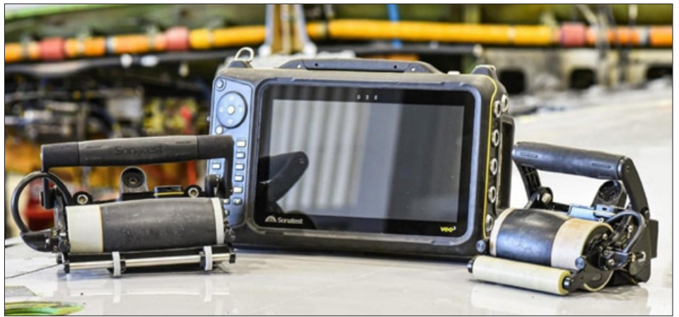
WheelProbe 2 mit 128 Elementen (links) und 64 Elementen (rechts). Dazwischen das portable PAUT-Gerät VEO3.
