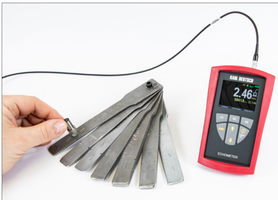
Justierung des ECHOMETER 1077 an der eigens vom Kunden angefertigten Fächer-Lehre mit unterschiedlichen Wanddicken
