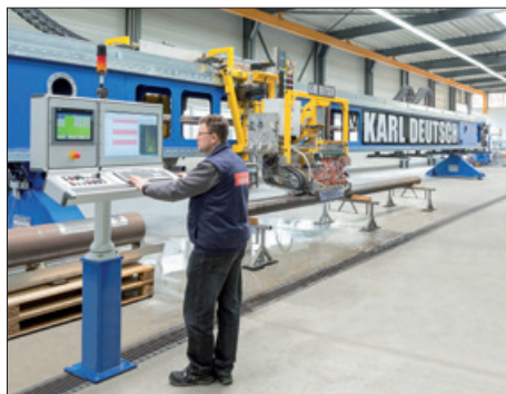
Im Werk 2 entstehen bis zu 35 m lange Ultraschall-Prüfanlagen.
