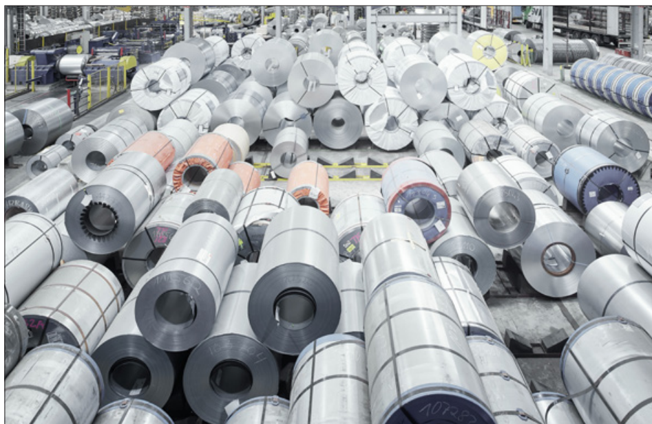
Große Bevorratung: Das Rohbandlager fasst über 60.000 Tonnen und liegt in vielen verschiedenen Güten vor. Das Fertigmateriallager hat eine Kapazität von über 10.000 Tonnen.
