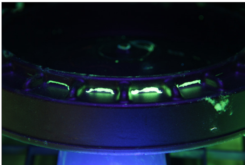
Fluoreszierende Anzeigen unseres KD-CHECK FP-WB-1 auf einem Aluminiumbauteil ohne Anwendung eines Entwicklers
