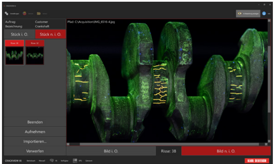
CRACKVIEW AI-Software zur automatisierten Detektion von Rissanzeigen
