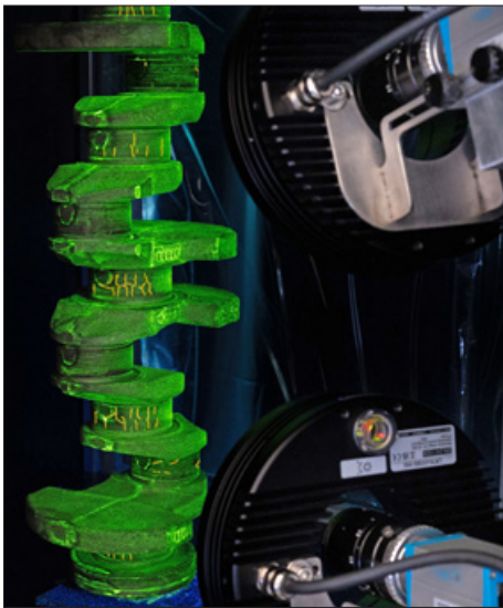
Kameraerfassung der Bauteiloberfläche unter UV-Licht
