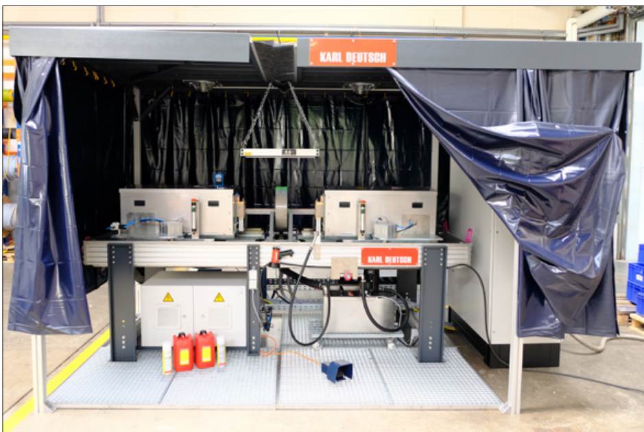
Frontansicht auf die Maschine mit Bodenwanne, Trittgitter und im Zugangsbereich geöffnetem Verdunklungsvorhang
