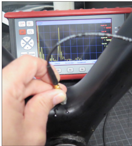
Ein Kohlefaser-Fahrradrahmen wird im Bereich des Tretlagers auf Delaminierungen überprüft.
