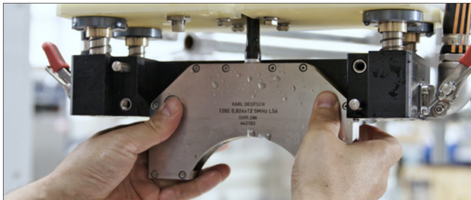
Einhängen des PAUT-Prüfkopfes
