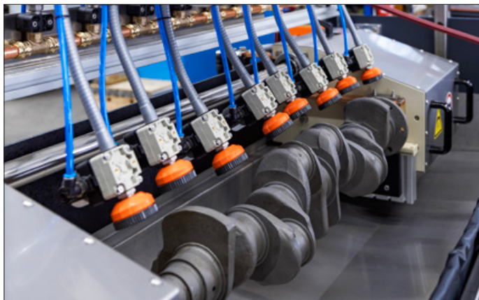
Acht Bespülduschen versorgen die gesamte Prüfteillänge mit dem Prüfmittel.
