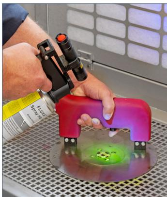
Ideal für den mobilen Prüfbetrieb mit dem DEUTROPULS-Handmagneten
