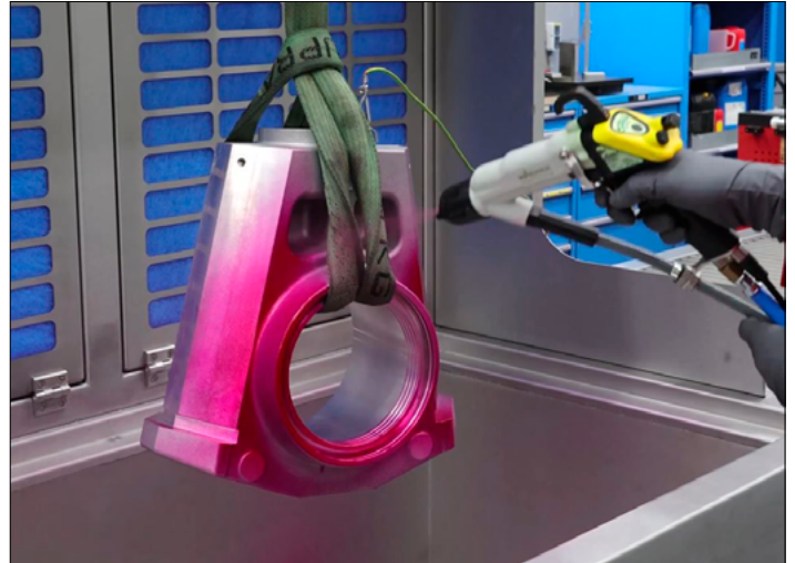
Prüfmittelauftrag an einer Eindringmittelstation mit Elektrostatik
