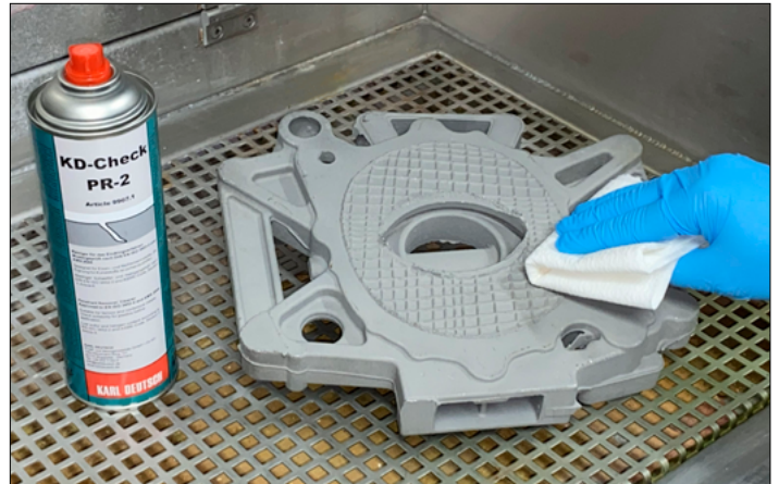
Vorreinigung eines Bauteils mit KD-CHECK PR-2
