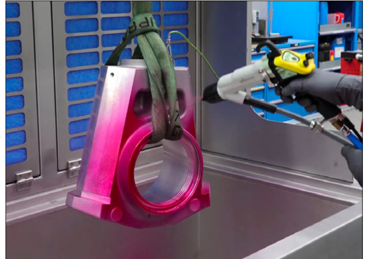
Prüfmittelauftrag an einer Eindringmittelstation mit Elektrostatik
