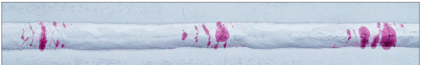
Rissanzeige mit rotem Farbeindringmittel auf einer Schweißnaht
