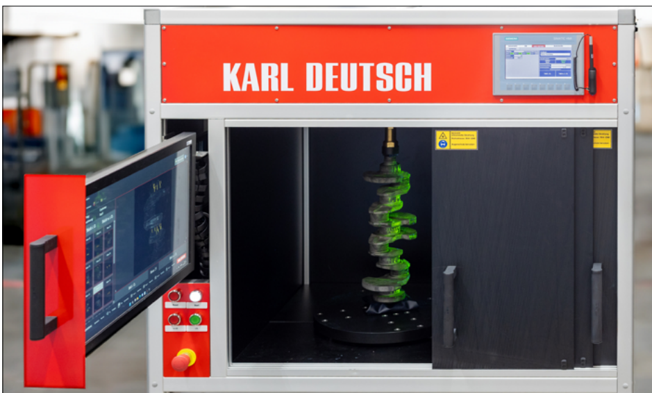
CRACKVIEW AI-Prüfplatz mit Prüfteil auf einem Drehteller
