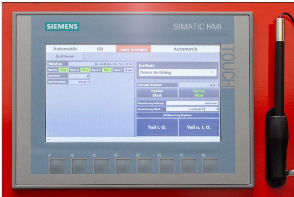
SIMATIC HMI Touchscreen zur Steuerung des Prüfablaufs
