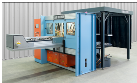
Beispiel für eine konventionelle DEUTROMAT-Magnetpulverprüfanlage mit Betrachtungskabine
