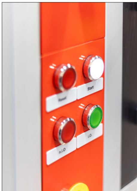
Hardwaretaster zur manuellen Bauteilbewertung
