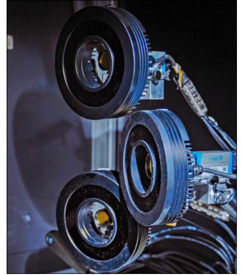
UV-Leuchten mit Kamerasystem
