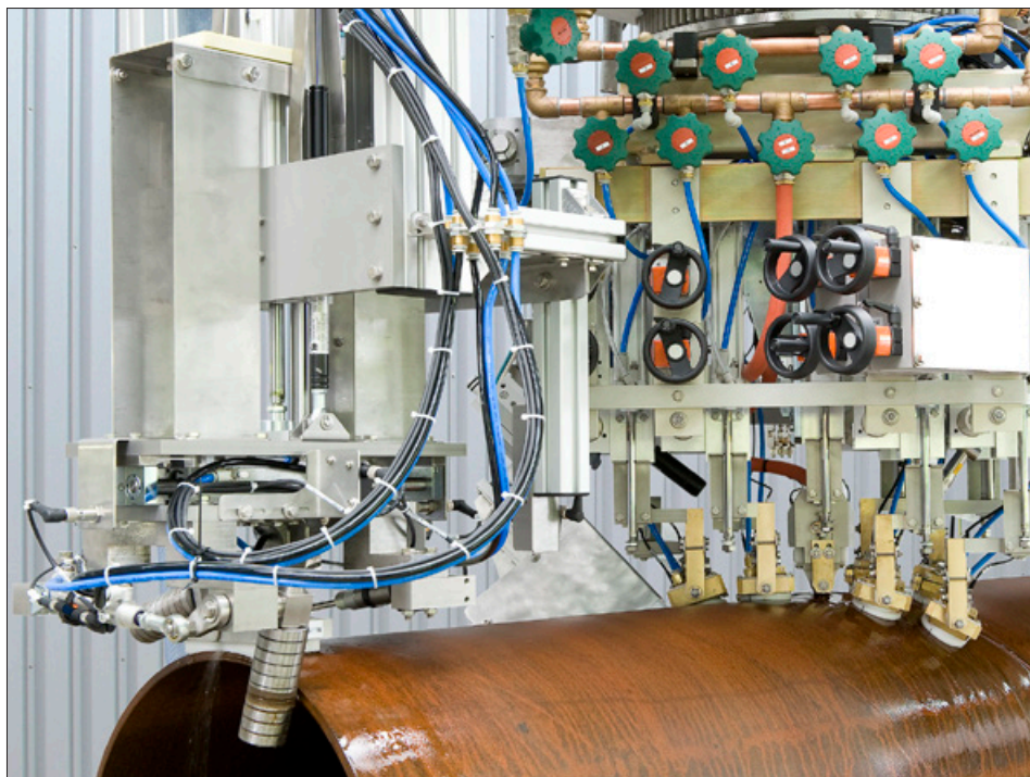
Beispielanlage ECHOGRAPH SNUS zur Ultraschallprüfung der Schweißnaht, des Rohrendes und der Wärmeeinflusszone
