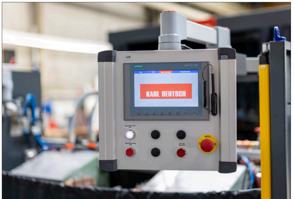
Komfortabel: Das Bedienpanel kann im Einrichtbetrieb direkt neben den Prüfbereich geschwenkt werden, ohne die Lichtschranke zu unterbrechen.
