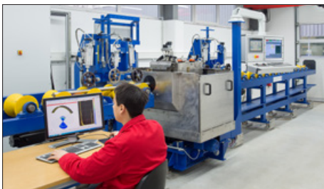
ECHOGRAPH HRPS-PAUT-Stangenprüfanlage in unserem Prüflabor – jederzeit einsatzbereit für kundenspezifische Versuche!
