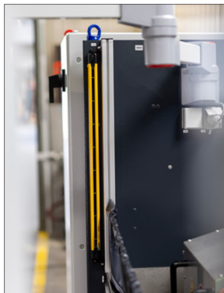
Lichtschranke mit Dreifachfunktion: Taktstart, Vermeidung von Klemmgefahr und Prüfteilzählung
