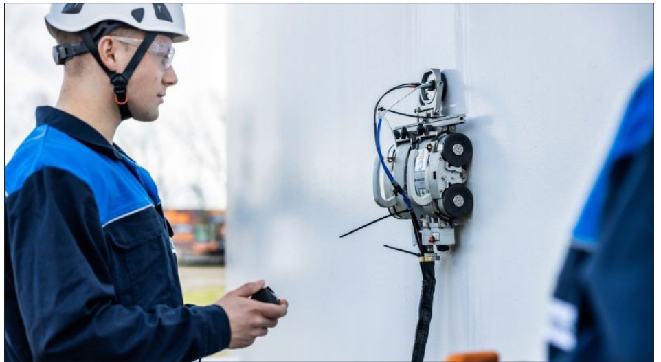
Effiziente Prüfung an der Tankwand: NAVIC 2 mit GEKKO im PAUT-Betrieb (130 mm/s)
