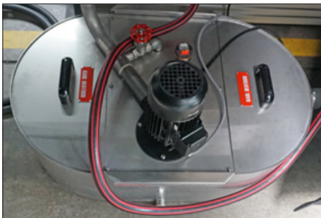
Prüfmittelbehälter mit Sensor zur Überwachung der Prüfmitteltemperatur
