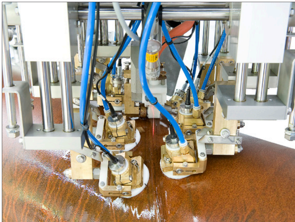
Beispiel der ECHOGRAPH SNUS-Prüfkopfträger mit automatischer Nahtverfolgung
