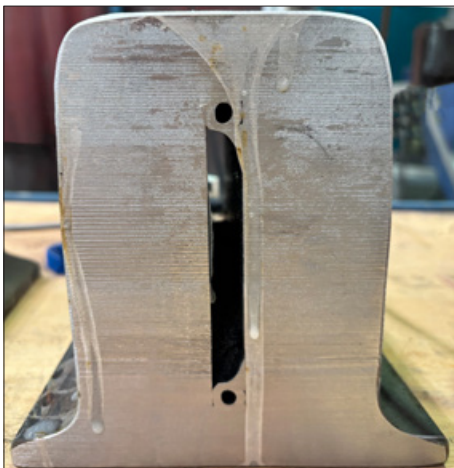
Schnitt eines Weichenherzstücks nach Wittener Bauart – kritischer Bereich im Umfeld des Rohrchens; Zone der Rissentwicklung
