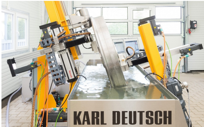
Abb. 4. Ultraschallprüfanlage für Bahnräder und Portalsystem zum Radtransport
