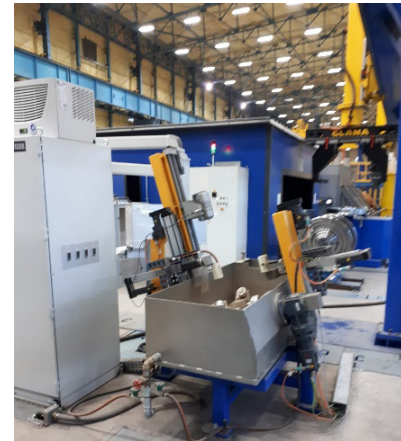
Abb. 4. Ultraschallprüfanlage für Bahnräder und Portalsystem zum Radtransport
