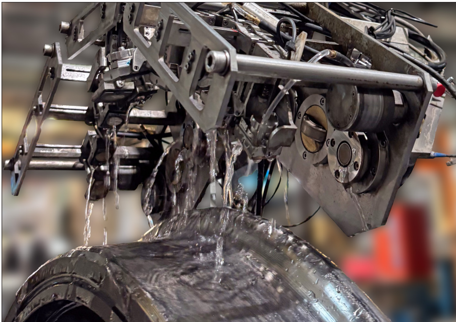
Der ECHOGRAPH WHEELSET V prüft mit bis zu 6 Phased Array-Prüfköpfen vollautomatisch auf Quer- sowie Volumenfehler ab 1 mm Tiefe.
