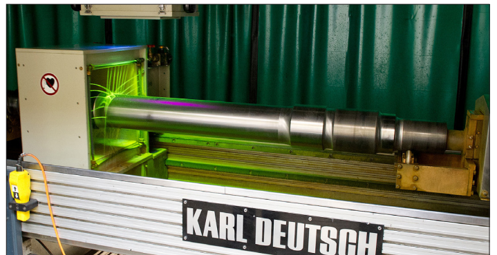
DEUTROFLUX UWS: Bewegliches Kabinendach ermöglicht Kranbeladung
