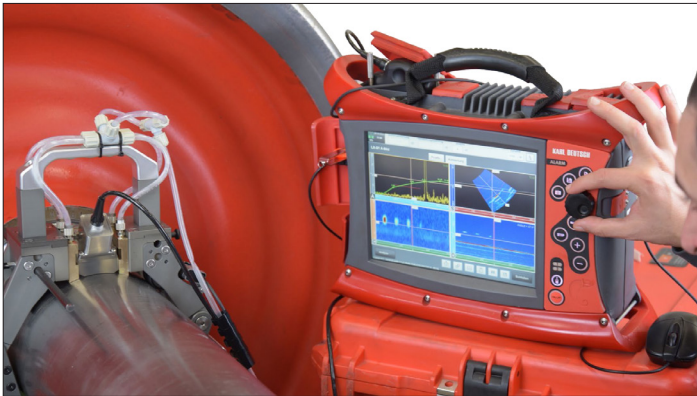
WS3: Halbautomatische Prüfung von Radsätzen. Zuerst wird die Welle geprüft, anschließend der Spurkranz mit einem zweiten Phased Array-Prüfkopfhalter.
