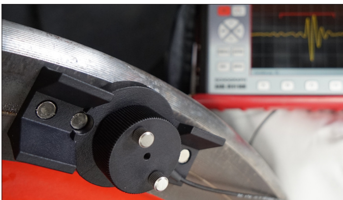
WS-RS: Die Eigen spannung wird mit einem Ultraschall-Prüfgerät mit extrem genauer Laufzeitmessung und einem speziellen Prüfkopf ermittelt.
