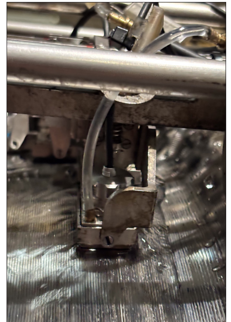
Der ECHOGRAPH WHEELSET V prüft mit bis zu 6 Phased Array-Prüfköpfen vollautomatisch auf Quer- sowie Volumenfehler ab 1 mm Tiefe.
