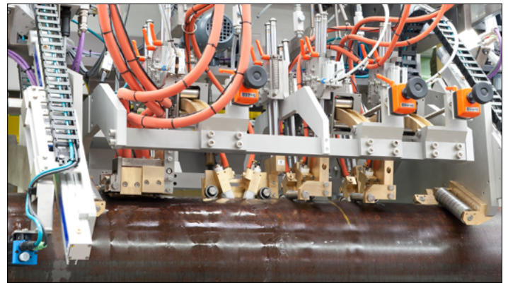
Beispielanwendung: Zehn Prüfköpfe für die Offline-Schweißnahtprüfung, sechs Winkelprüfköpfe mit Wasserstrahlkopplung. Der Einschallwinkel kann stufenlos eingestellt werden, ohne den Prüfkopf zu wechseln.
