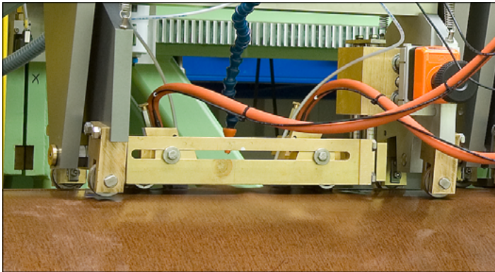
Prüfköpfe für die Querfehler-Erkennung auf der Raupe: Die Wasserstrahlkopplung ermöglicht die Positionierung der Prüfköpfe direkt über der Schweißraupe.
