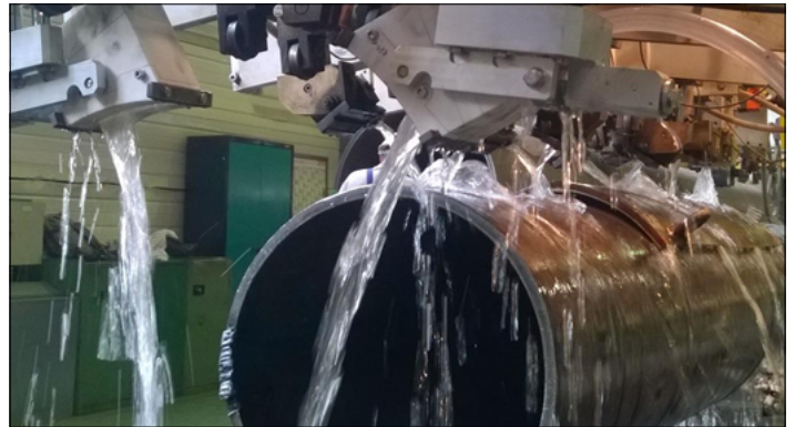
Auf Kundenwunsch können manche (oder alle) Prüffunktionen auch mit PAUT-Prüfköpfen durchgeführt werden (Bild mit freundlicher Genehmigung von EEW-Germany)
