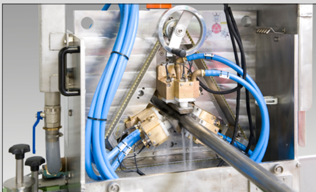
Die ECHOGRAPH STPS-Prüfanlage arbeitet mit drei Prüfkopfträgern (Koppelmittelabstreifer und Schutzgehäuse der Anlage sind in diesem Bild demontiert). Jeder Prüfkopfhalter nimmt einen Prüfkopf für Senkrechtschallung auf. Zur Erkennung von oberflächennahen Fehlern können auch zwei Winkelprüfköpfe pro Prüfkopfhalter integriert werden.
