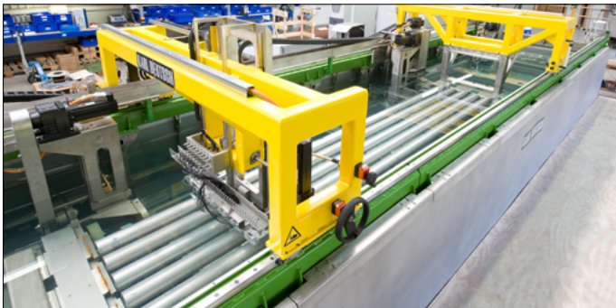
Großer Tauchtank zur Prüfung von Stangen, Profilen und Rohren. Es können bis zu sechs Teile gleichzeitig geprüft werden.
