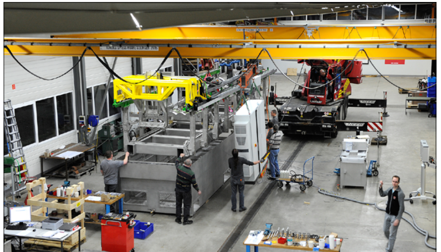
Blick in den Anlagenbau, wo ein großer Tauchtank montiert wird
