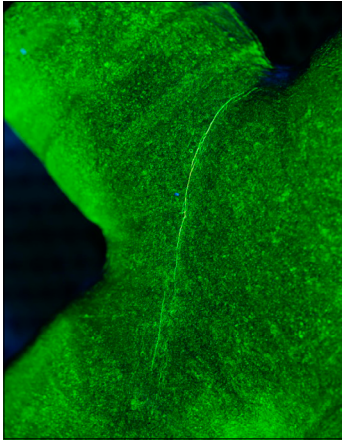
Rissanzeige mit fluoreszierendem Magnetpulver
